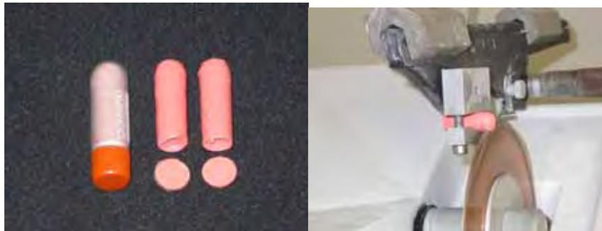
FIGURA 6 - Moldes de guta-percha e Resilon e os discos obtidos após o corte na máquina Isomet.
