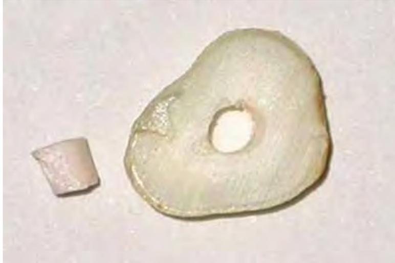
Figura 3 - Cimento obturador (Epihany) deslocado do disco de dentina após teste de *push-out*.
