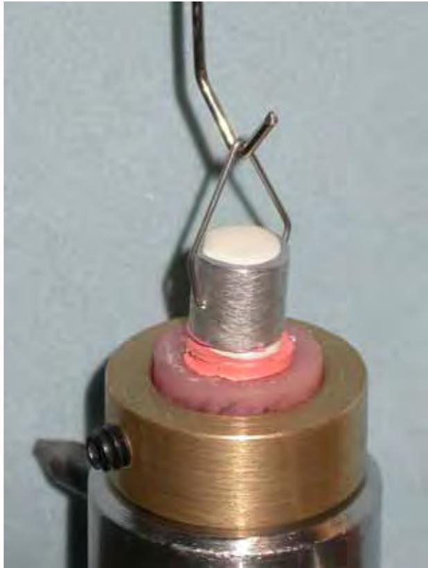
Figura 11- Conjunto sendo tracionado até o rompimento do cimento testado e material sólido de obturação.
