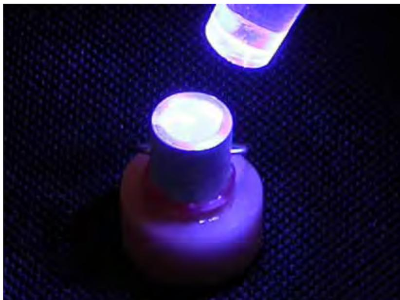
Figura 10 - Fotopolimerização do cimento Epiphany após o preenchimento do anel metálico.
