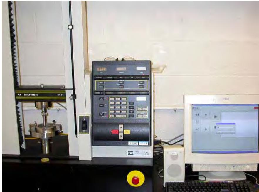
FIGURA 1 - Máquina Universal de Ensaio (Instron 4411) acoplada a computador para obtenção dos resultados do teste de *push-out*.
