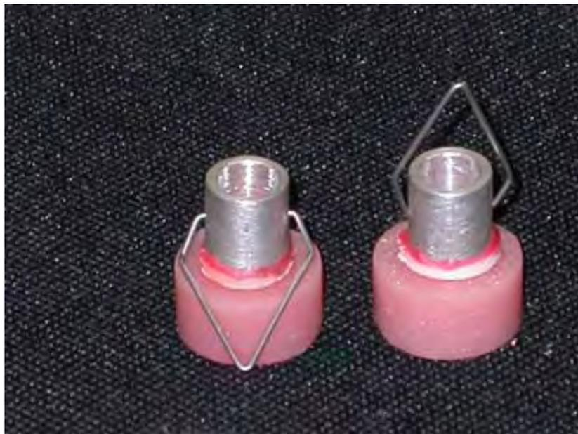
FIGURA 8 - Anéis metálicos montados sobre a guta-percha e Resilon, rodeados por uma camada de cera para evitar extravasamento dos cimentos.
