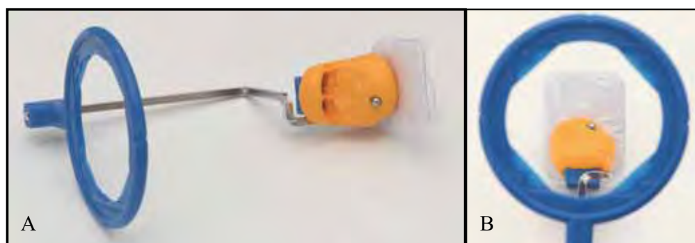
Figura A6. A- Posicionador e filme radiográfico com registro em silicone e esfera metálica. B- Vista frontal da área de incidência dos Raios x sobre o conjunto.
