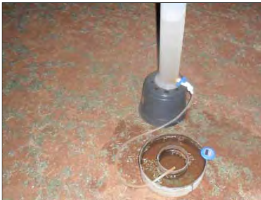
Figura 11. Determinação da velocidade de infiltração básica da água no solo (VIB) através do método dos anéis concêntricos.
