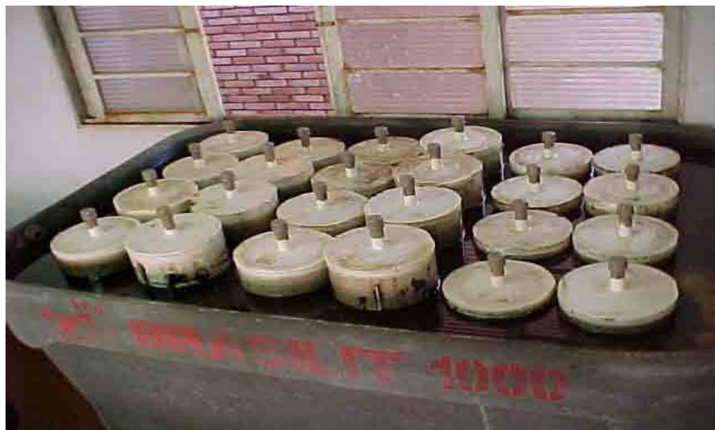
Figura 9. Caixa de fibrocimento contendo os gasômetros independentes.
