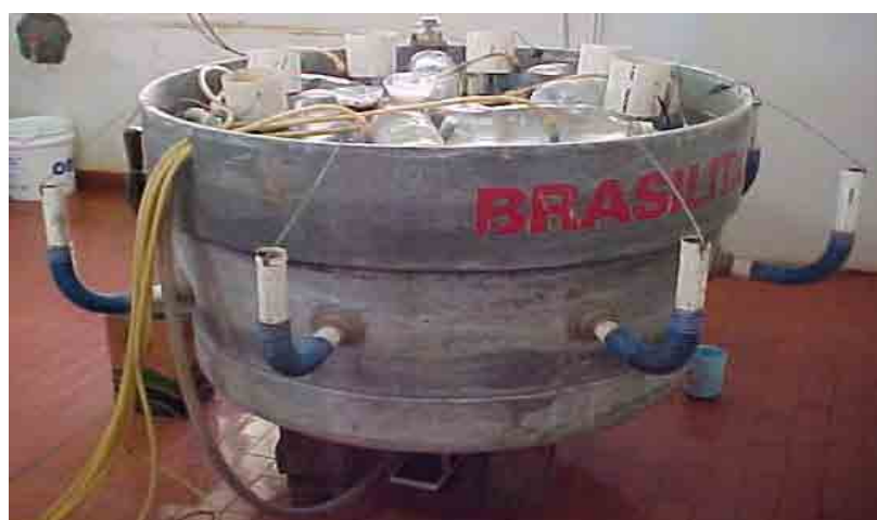
Figura 8. Caixa de fibrocimento contendo oito biodigestores de bancada.
