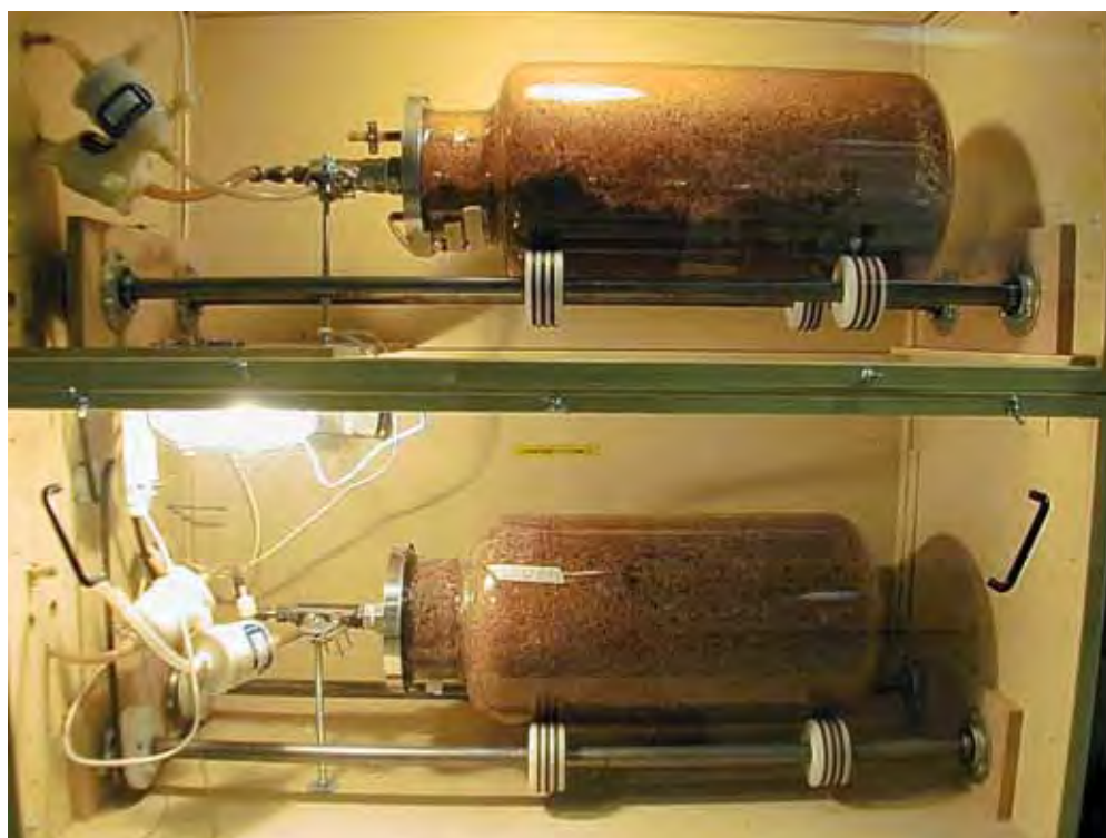
Figura 1. Bioreator instalado com o experimento de atividade enzimática do L. edodes durante crescimento em serragem de eucalipto.
