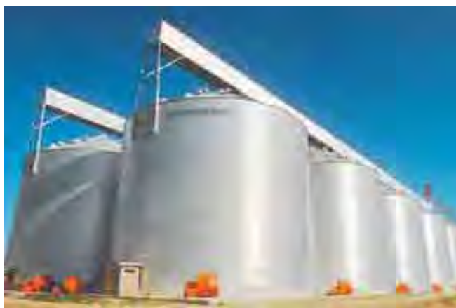
Figura 7 - Silo metálico, plano, vertical - conservação de grãos
