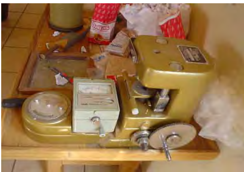
Figura 31 – Medidor de umidade
