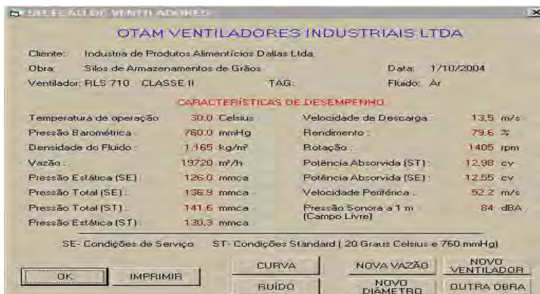
Figura 16 – Características de desempenho de um ventilador RLS -710
