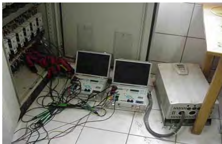
Figura 37 - Ligações dos analisadores de energia e inversor de frequência
