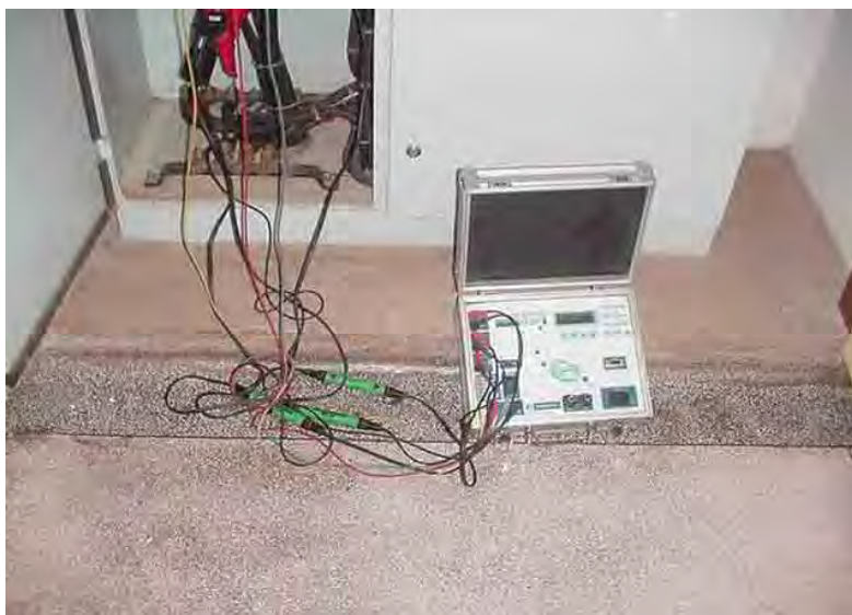
Figura 40 - Analisador de energia, modelo RE-2000
