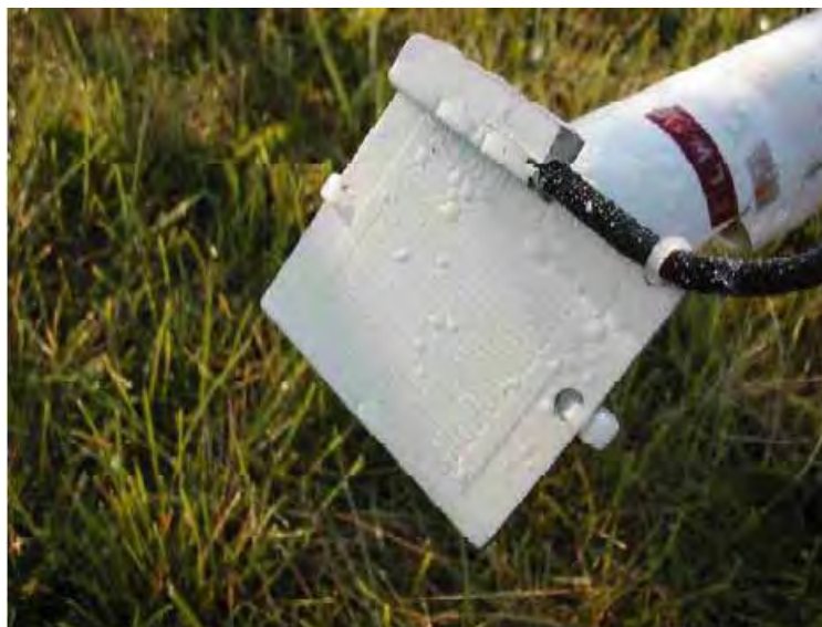
Figura 15 – Detalhes de um sensor de molhamento Campbell modelo 237
