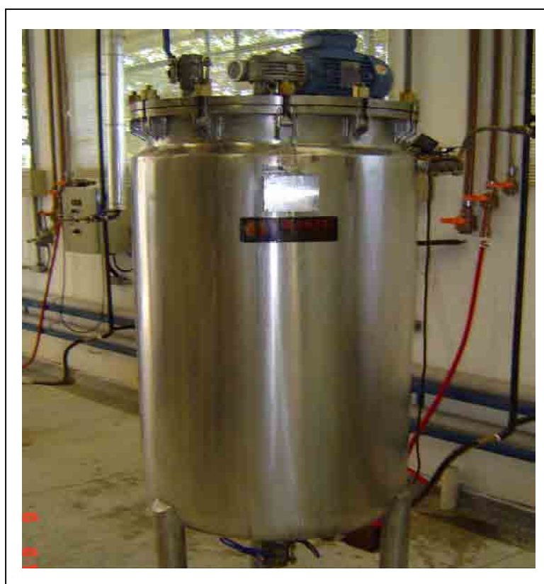
Figura 10 – Reator de hidrólise com capacidade de 150 litros, dotado de sistema de agitação e camisa de aquecimento com vapor.
