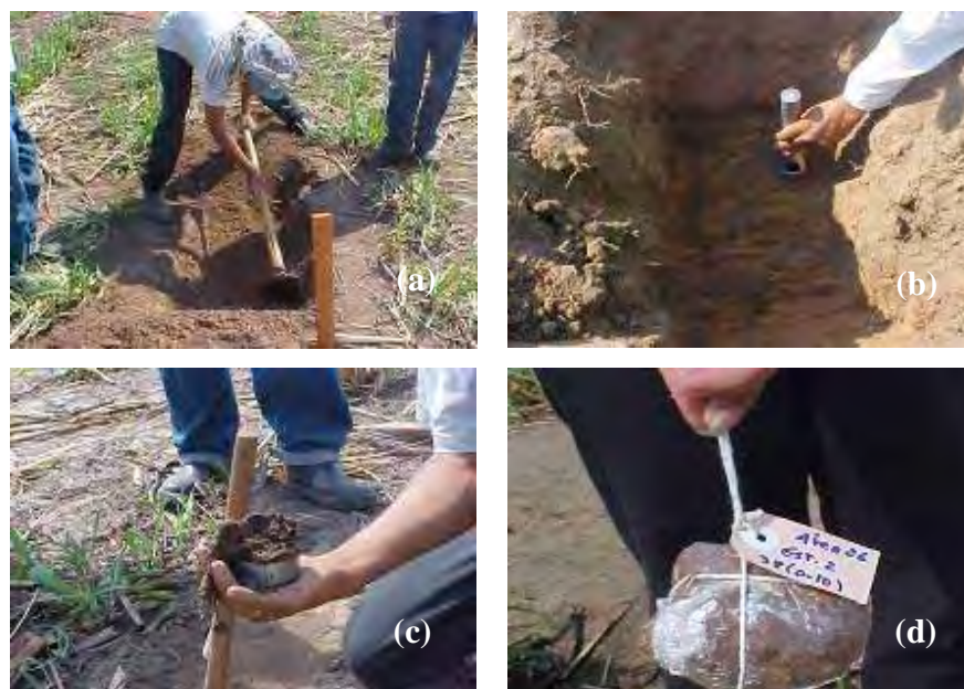
Figura 2. Procedimento para a coleta de amostras indeformadas a serem ensaiadas em laboratório: (a) limpeza do terreno ou acesso a camada subsuperficial (profundidade 2); (b) coleta da amostra com o anel; (c) limpeza da amostra; e (d) embalagem e identificação da amostra.
