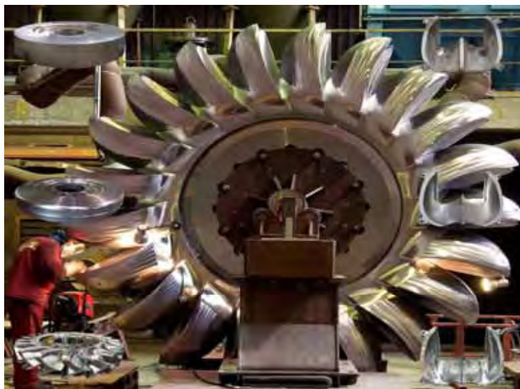
Fonte: INSTITUTO INDUSTRIALE – NOVARA (2007). Figura 9 - Rotor Pelton.
