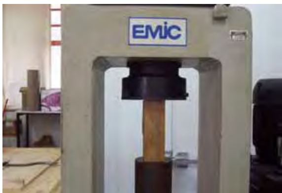
Figura 13 – Painel de 25 lâminas - Ensaio de compressão paralela às fibras.
