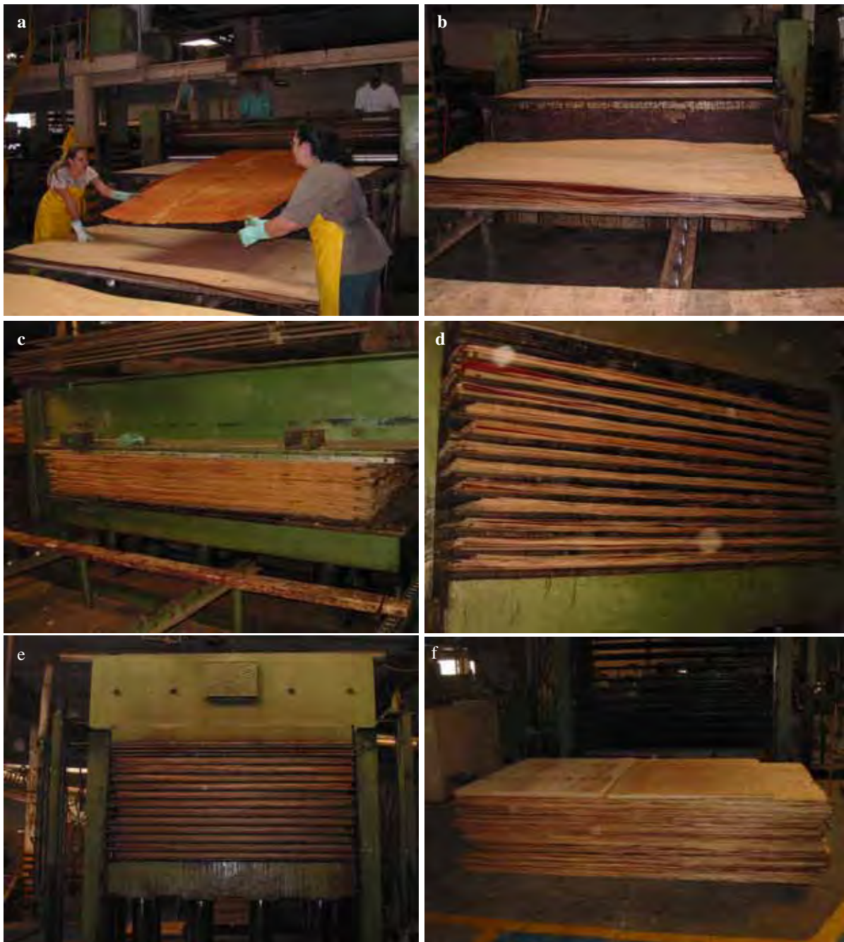
Figura 6 – Fabricação de painéis LVL. a) aplicação de cola nas lâminas; b) montagem das lâminas; c) pré-prensagem à frio; d) entrada dos painéis à prensa quente; e) prensagem à quente, e f) saída dos painéis da prensa.
