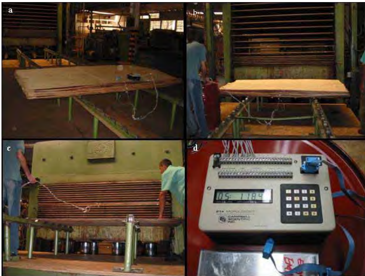
Figura 3 - Instalação dos termopares no painel comercial. a) e b) instalação no interior das lâminas antes da entrada na prensa; c) prensagem do painel e d) vista geral do Micrologger.
