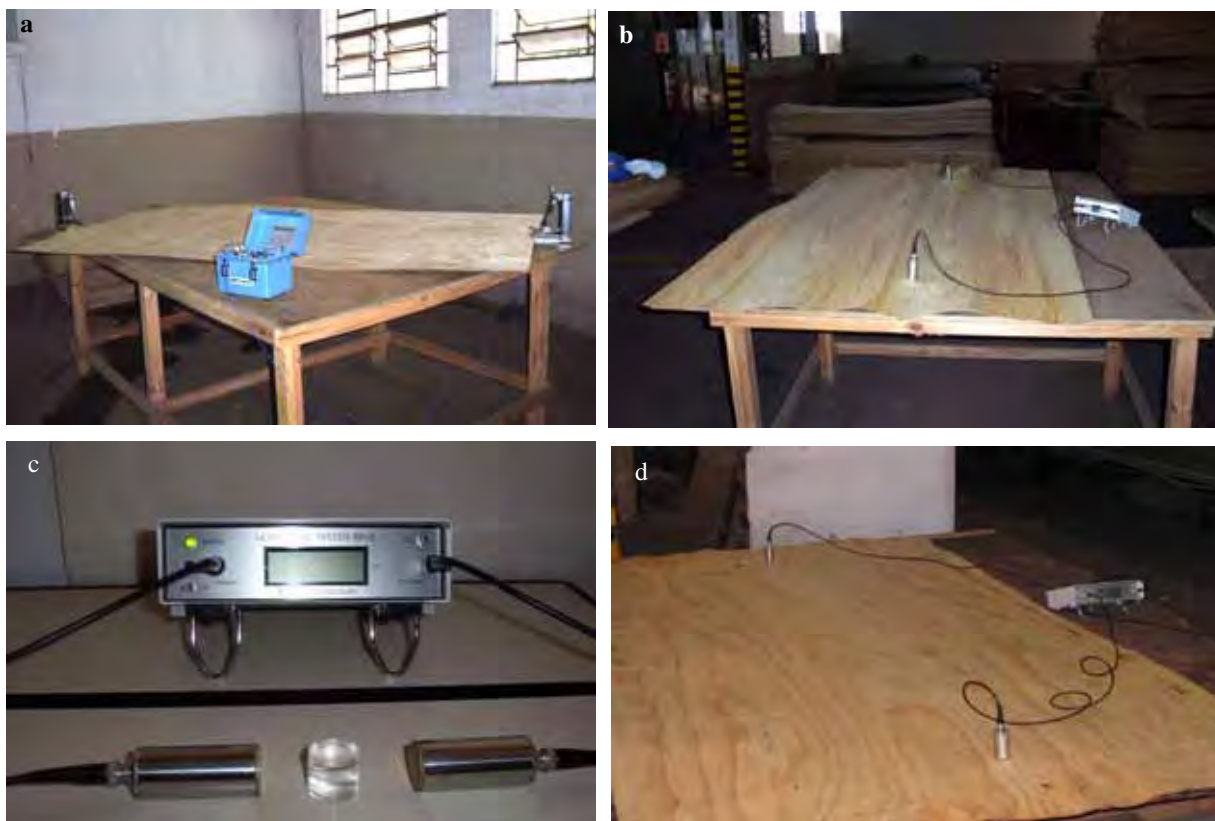
Figura 5 - Ensaio não-destrutivo nas lâminas; a) ondas de tensão - Stress Wave Timer ; b, c e d) equipamento de ultra-som Steinkamp modelo BP-7 e ensaios de ultra-som.
