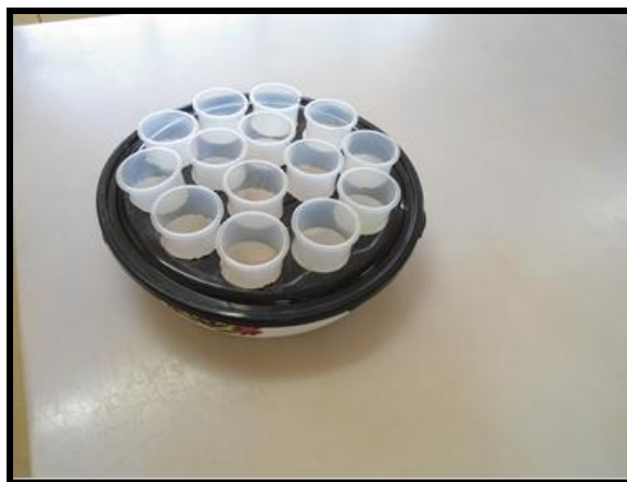
Figura 1. Suporte para 14 frascos de material transparente ao micro-ondas e frasco plástico de polietileno ou polipropileno com capacidade 100 mL.
