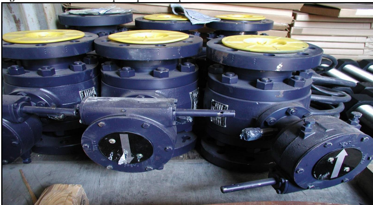
Figura 22 - Válvulas de bloqueio que fariam parte do alcooduto.
