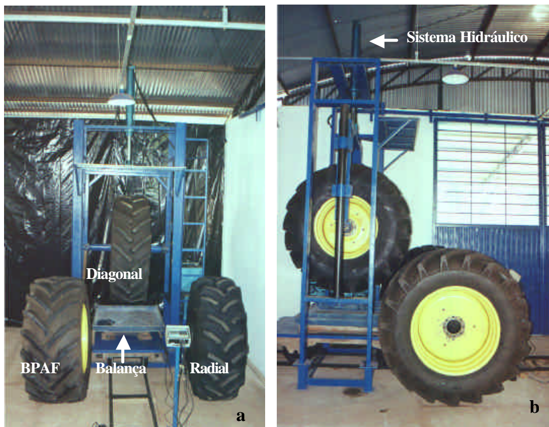
Figura 17: Vista frontal (a) e lateral (b) da prensa de ensaios estáticos de pneus e pneus utilizados.
