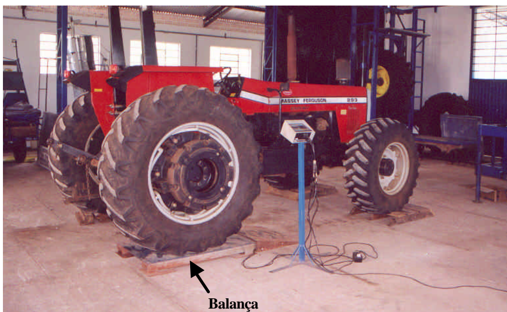
Figura 24: Vista parcial da determinação dos parâmetros necessários ao cálculo da posição do centro de gravidade do trator.
