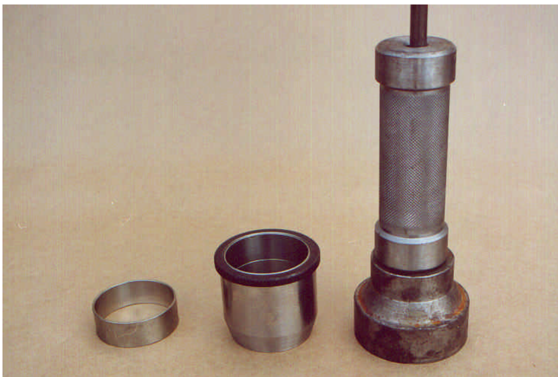
Figura 16: Equipamento especialmente construído para coleta de amostras indeformadas de solo, tendo-se, da esquerda para a direita, um anel, a ferramenta porta-anéis com borda inferior cortante e o conjunto de percussão.
