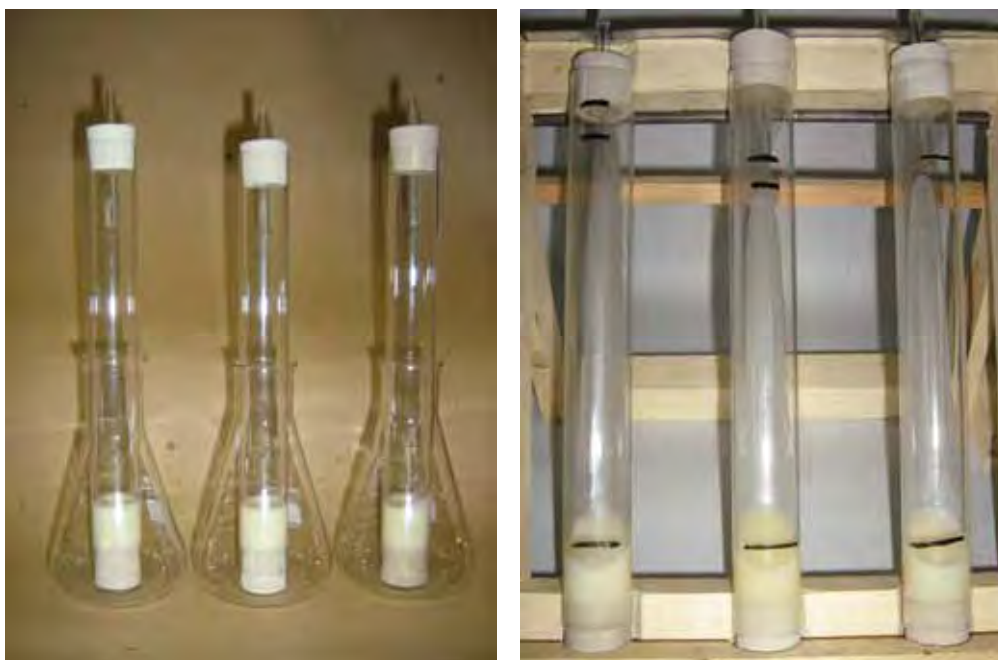
Figura 18 – Amostras de requeijão cremoso modificado, submetidas ao teste de capacidade de derretimento.
