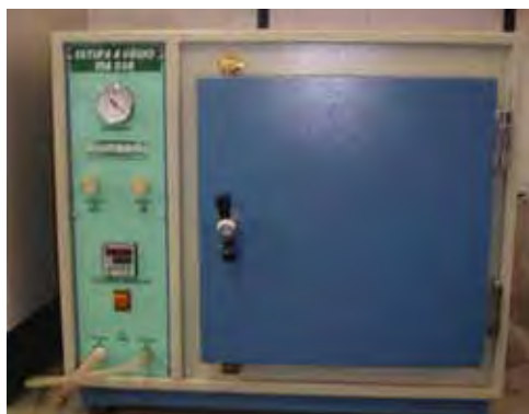
Figura 2.4: Estufa a vácuo utilizada na secagem de polpa de maracujá.
