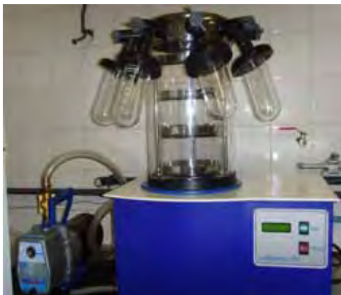
Figura 2.3: Liofilizador utilizado na secagem de polpa de maracujá.
