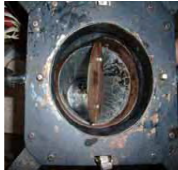
Figura 4.6: Válvula borboleta aberta (90°) responsável pelo sistema de pulsação.
