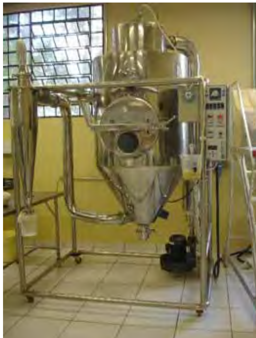
Figura 2.2: Spray dryer utilizado para secagem da polpa de maracujá.
