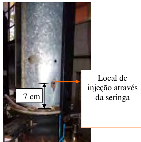
Figura 4.4: Vista lateral da câmara de secagem com orifício de injeção de alimentação.
