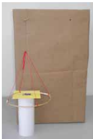
Figura 102: Aro de madeira na posição horizontal preso por quatro linhas de algodão amarradas a uma linha de seda. Esta está fixada a um palito de madeira fincado em uma caixa de papelão. A figura também ilustra os pedacinhos de papel de seda utilizados como detectores de eletrização, os quais estão posicionados sob o aro de madeira e sobre uma folha de papel sulfite. Como suporte para os papezinhos de papel de seda foi utilizado um cilindro feito com uma folha de papel sulfite.
