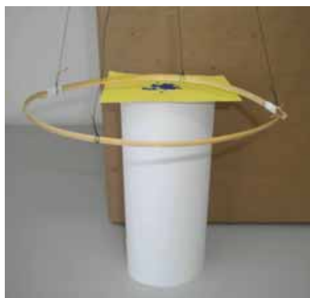
(b) Em detalhe o aro de madeira na posição horizontal preso por quatro linhas de seda, juntamente aos pedacinhos de papel de seda utilizados como detectores de eletrização, os quais estão posicionados sob o aro de madeira e sobre um pedaço de papel sulfite. Como suporte para os papezinhos de papel de seda foi utilizado um cilindro feito com uma folha de papel sulfite.
