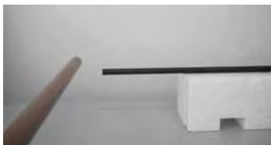
Figura 193: Tubo de PVC sendo aproximado da barra de ferro de forma que fiquem ortogonais.
