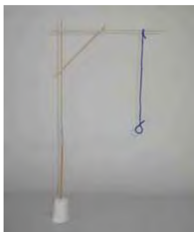
Figura 85: Aparato utilizado para sustentar o fio condutor, feito com suporte com base de gesso, palitos de madeira e linha de algodão.
