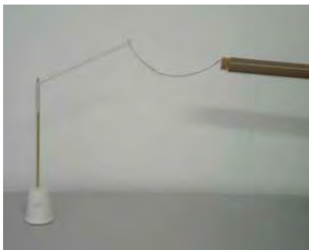
Figura 76: A figura ilustra uma linha pendular de algodão grudada em uma cortiça colocada à extremidade de um tubo de PVC após ser atritado com poliamida. A linha permanece desta forma por poucos instantes, logo em seguida é repelida pela cortiça.
