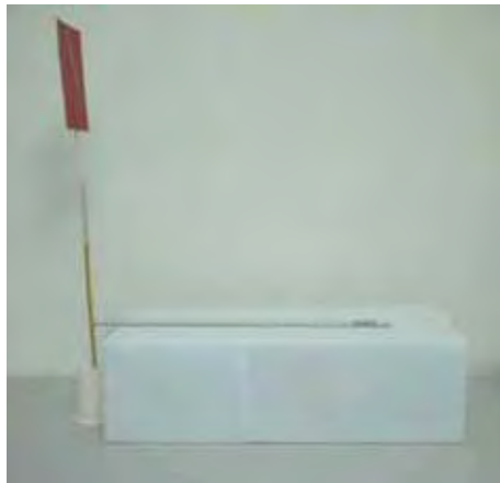
(a) À esquerda temos um eletroscópio, ao centro há um apoio para a régua (neste caso utilizamos uma caixa de sapato) e uma régua de 30 cm apoiada sobre a caixa.
