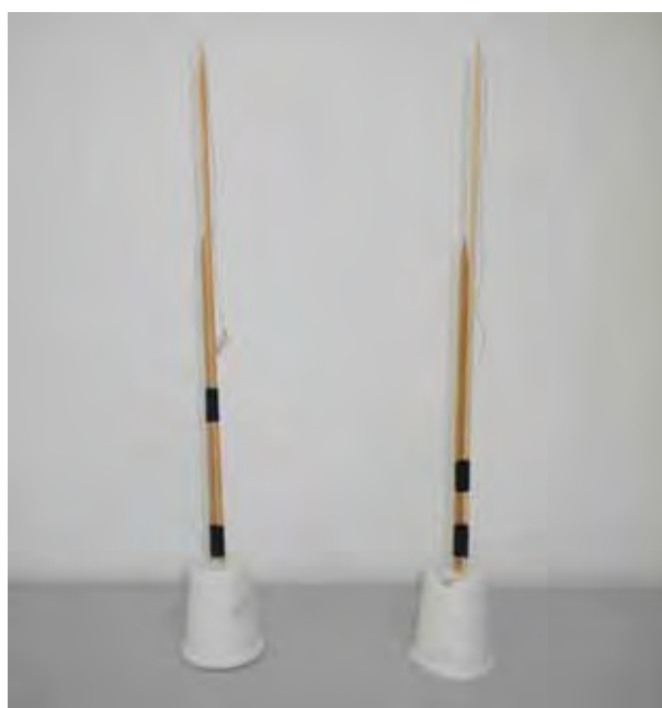
Figura 45: À esquerda o instrumento com a penugem presa à ponta da linha de seda, à direita o instrumento sem a penugem.
