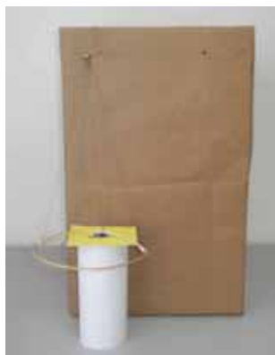
(a) Aro de madeira na posição horizontal preso por quatro linhas de seda a um palito de madeira fixado em uma caixa de papelão. A figura também ilustra os pedacinhos de papel de seda utilizados como detectores de eletrização.
