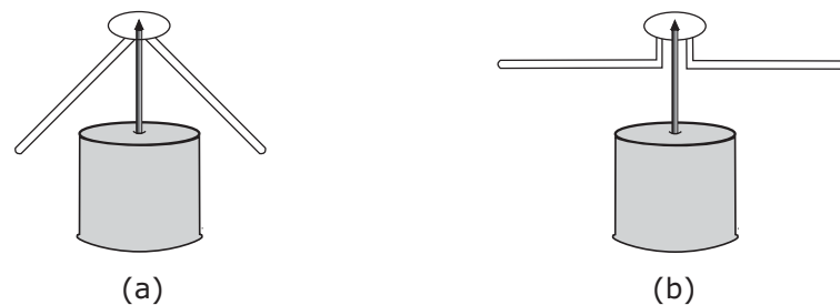
Figura 6: (a) Versório com a haste horizontal em forma de “ \wedge ”. (b) Versório com a haste horizontal dobrada de forma que a parte circular do colchete, em contato com o alfinete, fique acima do plano estabelecido pelas suas hastes. Figuras adaptadas de (RIPE, 1990, “ versorium ”).
