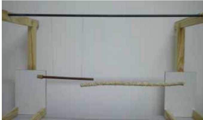
Figura 169: A figura apresenta uma vareta de madeira com uma rolha de cortiça à sua ponta e um pedaço de corda, ambos na posição horizontal, suspensos pela haste horizontal de ferro do suporte de madeira. A vareta de madeira está presa por linhas de seda à haste e a corda está presa por linhas de poliamida (linhas de pesca).
