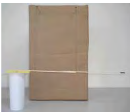
(a) Vareta de 50 cm presa por linhas de seda a palitos de madeira fixados em uma caixa de papelão. Abaixo da extremidade esquerda da vareta há pedacinhos de papel de seda utilizados como detectores de eletrização, os quais estão colocados sobre um pedaço de papel sulfite. Como suporte para os papeizinhos de papel de seda foi utilizado um cilindro feito com uma folha de papel sulfite.
