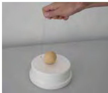
Figura 211: No alto da figura uma mão segura a linha de seda, em cuja extremidade inferior está presa uma bolinha de cortiça. A cortiça gira, no plano equatorial, ao redor de uma esfera eletrizada de madeira colocada sobre uma base de PVC atritada.
