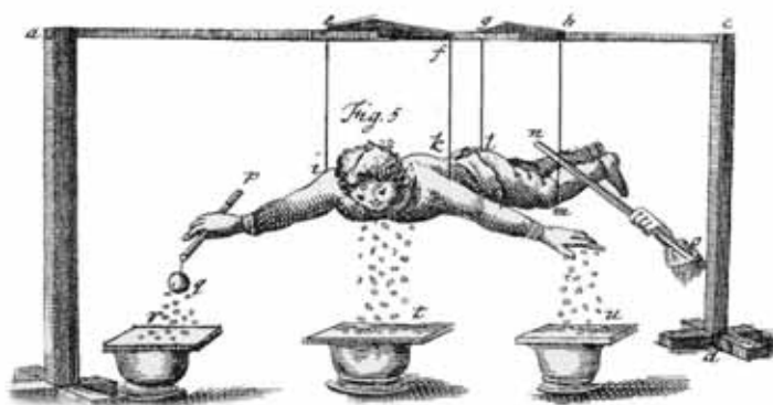
Figura 72: Ilustração dos experimentos de Gray com o garoto suspenso em linhas muito finas. Um tubo de vidro atritado é mantido próximo às suas pernas. As mãos e o rosto do garoto atraem lâminas de latão. Figura extraída de (DOPPELMAYR, 1774), também disponível em (HEILBRON, 1979, p. 247).
