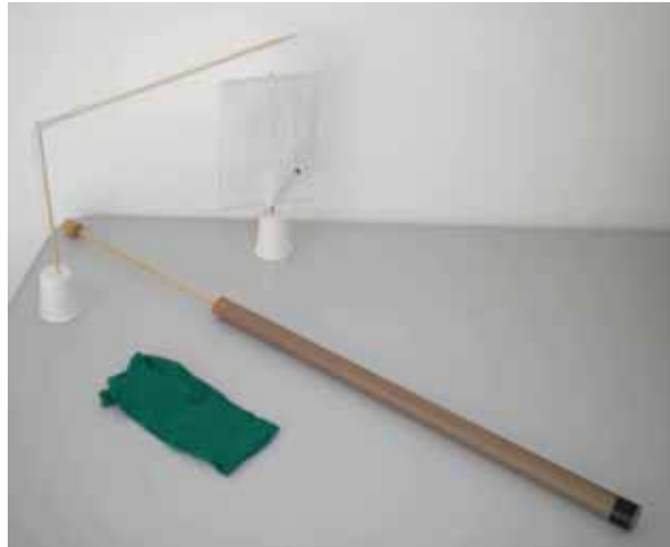
Figura 80: A figura mostra o tubo de PVC com uma rolha (A), vareta de madeira e a segunda rolha (B); o material de poliamida utilizado para a eletrização do tubo; e os instrumentos para verificação da eletrização, i.e. , anteparo de papel sulfite aterrado e disco de papel de seda preso em uma linha de seda fixada em um suporte.
