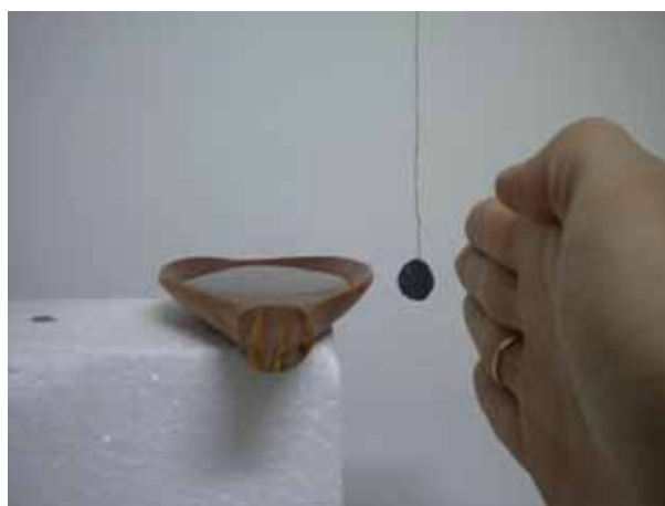
Figura 117: A figura mostra a posição da colher de madeira, do disco de papel de seda e da mão para a realização do experimento.
