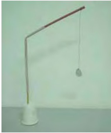
(a) Ilustração de um pêndulo completo. Neste caso, feito com um disco de papel alumínio.
