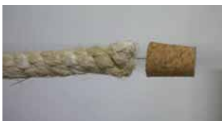
Figura 173: Em detalhe a figura apresenta como foi feita a fixação da rolha de cortiça à corda por meio de uma agulha de costura.
