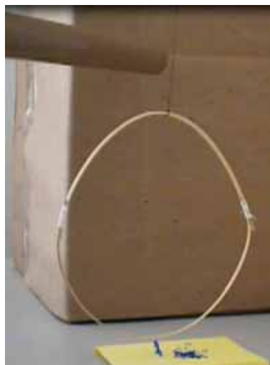
Figura 100: O aro de madeira preso a uma linha de seda atraindo pedacinhos de papel de seda colocados sobre um pedaço de papel sulfite após eletrizar o tubo de PVC por meio de atrito com poliamida e aproximá-lo da parte superior do aro.
