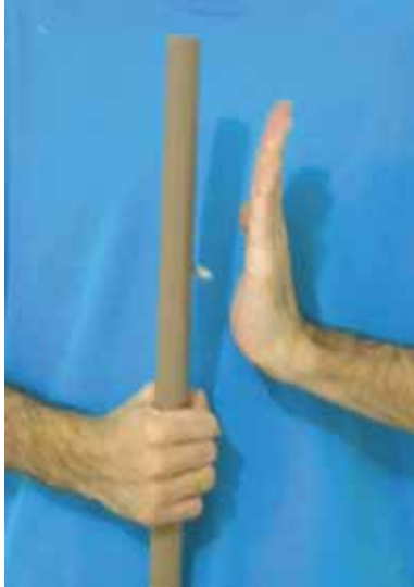
(a) Penugem oscilando entre a mão e tubo de PVC atritado com poliamida
