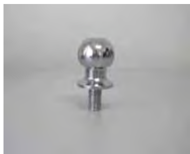
Figura 195: Em detalhe a bola metálica de 5 cm de diâmetro.
