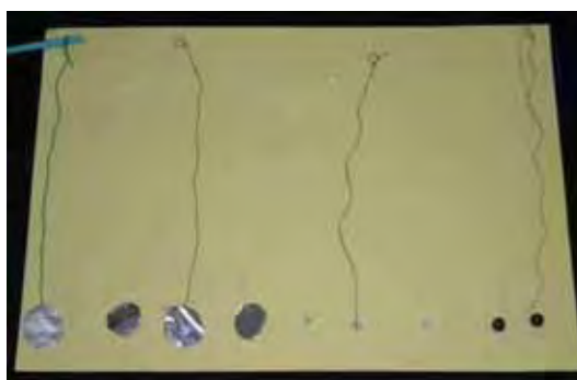
Figura 33: Alguns fios de pêndulos construídos. Da esquerda para direita - i) 4 pêndulos com disco de papel de alumínio: linha de poliamida (de “meia de seda”), linha de poliamida (linha de pesca), linha de seda, linha de algodão; ii) 3 pêndulos de bolinha de papel de alumínio: linha de poliamida (linha de pesca), linha de seda, linha de algodão; e iii) 2 pêndulos com chumbada de pesca (as menores encontradas no comércio): linha de algodão, linha de seda.
