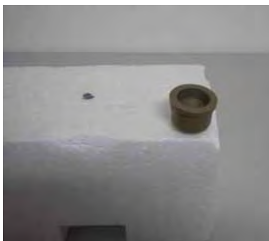
Figura 119: Recipiente de PVC (“CAP” de 2 cm de diâmetro interno) cheio de água e sobre uma base de isopor.
