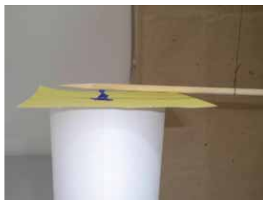
(b) A figura ilustra em detalhe a atração dos pedacinhos de papel de seda pela vareta de madeira quando o tubo de PVC eletrizado é aproximado da extremidade oposta àquela que está sobre os papeizinhos.
