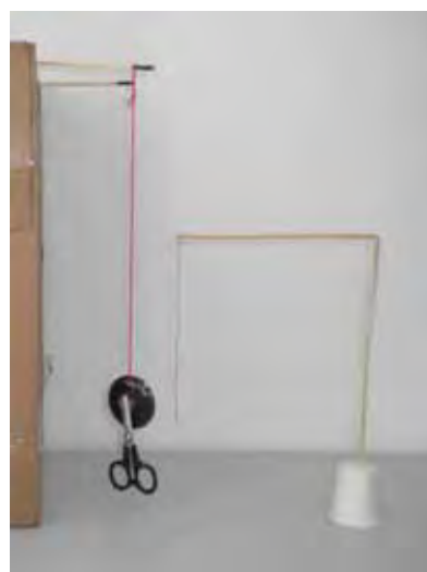
(b) Ímã preso por uma linha de algodão a um palito de madeira que está fixado em uma caixa de papelão. A figura também ilustra a linha pendular utilizada como detector de eletrização e a tesoura “fixada” ao ímã.
