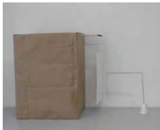
(b) Folha de papel sulfite (A4) presa por linhas de algodão a palitos de madeira que estão fixados em uma caixa de papelão. A figura também ilustra a linha pendular utilizada como detector de eletrização. Foto lateral do aparato.
