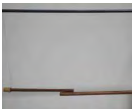
Figura 168: Em detalhe a figura apresenta duas varetas de madeira na posição horizontal presas à haste horizontal de ferro do suporte de madeira. A vareta da esquerda com uma rolha de cortiça à sua ponta está presa por linha de seda à haste e a vareta da direita está presa por linhas de poliamida (linhas de pesca).
