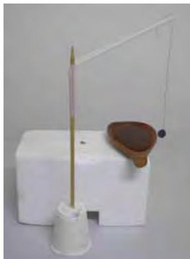
Figura 116: Sobre a base de isopor está posicionada uma colher de madeira sem cabo, dentro da colher há uma certa quantidade de água. A figura também mostra um pêndulo elétrico. Isto é, um suporte com base de gesso, fixado a ele tem um canudinho de refresco como haste horizontal no qual está presa uma linha de seda com disquinho de papel de seda na ponta inferior.
