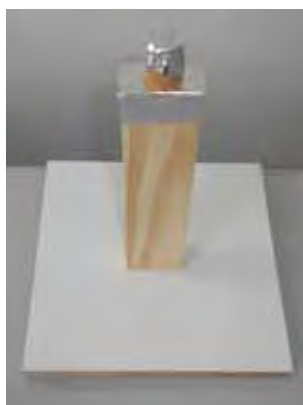
Figura 115: Suporte de madeira (base + haste vertical) com a extremidade superior envolta por papel alumínio, uma rolha de cortiça também envolta com papel alumínio sobre a haste vertical e uma gota de água colocada sobre o papel alumínio da rolha.
