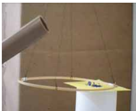
Figura 103: O aro de madeira preso a quatro linhas de seda atraindo pedacinhos de papel de seda colocados sobre um pedaço de papel sulfite após eletrizar o tubo de PVC por meio de atrito com poliamida e aproximá-lo do aro.
