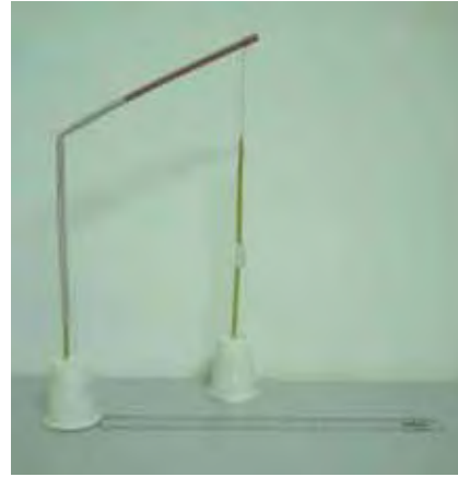
(b) O poste de sustentação ao fundo é referência para verificar quanto o pêndulo se desloca em relação à posição inicial. A régua na figura é para dar noção de profundidade entre os dois postes.
