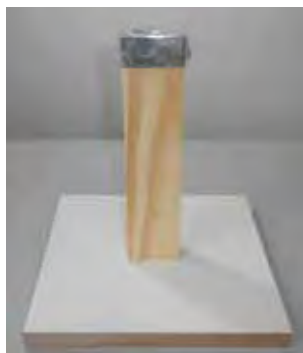
Figura 114: Suporte de madeira (base + haste vertical) com a extremidade superior envolta por papel alumínio e uma grande gota de água colocada sobre o papel alumínio.
