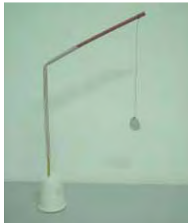
Figura 9: Ilustração de um pêndulo completo. Neste caso, feito com um disco de papel alumínio.
