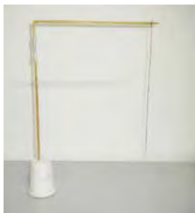
(a) Poste de sustentação com um palito de madeira colocado na sua ponta em forma de “Γ”. Na extremidade do segundo palito tem uma linha de algodão.
