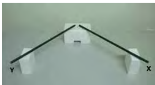
Figura 194: Duas barras metálicas de 50 cm colocadas em forma de “V” sobre bases de isopor.
