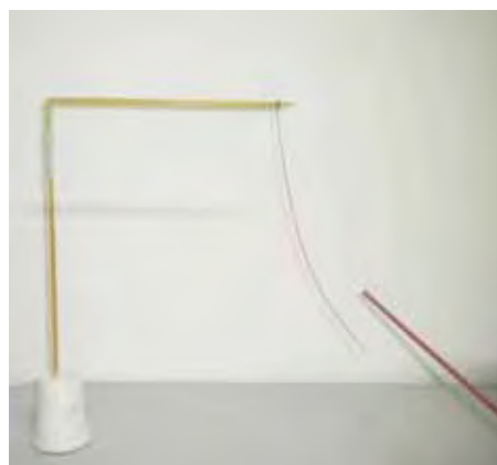
(b) Linha de algodão sendo atraída por um canudo eletrizado.
