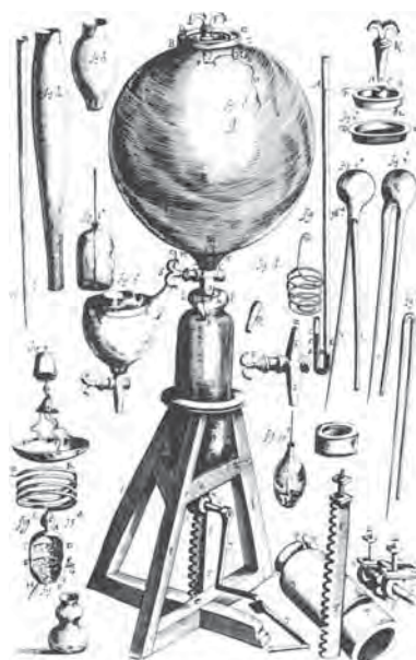
Figura 142: Gravura da bomba de ar desenvolvida por Robert Boyle. A bomba de ar completa é mostrada ao centro, e algumas de suas partes estão ao redor dela. Extraída de (WEST, 2005).
