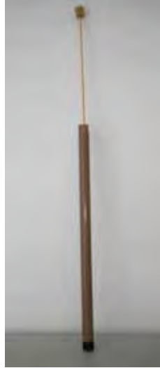
Figura 79: Tubo de PVC com uma rolha de cortiça (“A”) em sua extremidade, uma vareta de madeira colocada nesta cortiça e uma segunda rolha (“B”) colocada na extremidade da vareta que está mais afastada do tubo de PVC.
