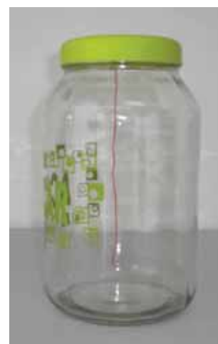
(b) Em detalhe um recipiente de vidro com uma linha de algodão presa na sua tampa pelo lado de dentro.
