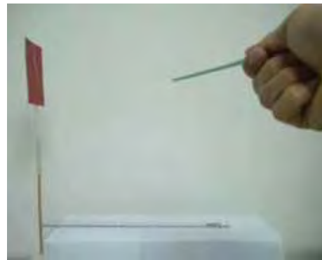
(b) Ilustração da medida sendo realizada. À direita o canudo segurado pela mão é aproximado do eletroscópio.
