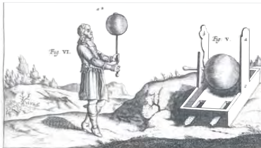
Figura 21: Experimento em que Guericke mantém uma penugem flutuando acima de uma esfera de enxofre atritada. Extraída de (GUERICKE, 1672, p. 129).
