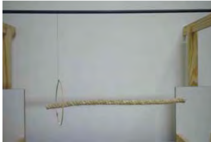
Figura 170: A figura apresenta um aro de madeira e um pedaço de corda suspensos na haste horizontal de ferro do suporte de madeira. O aro de madeira está preso por linha de seda à haste e a corda está presa por linhas de poliamida (linhas de pesca).
