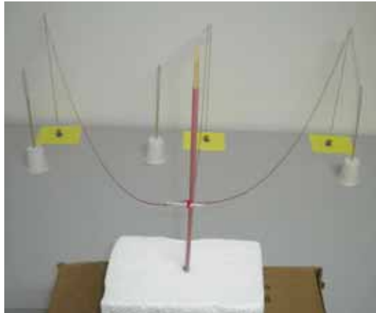
Figura 96: Aparato utilizado para o experimento em “ que a virtude elétrica pode ser transportada ao mesmo tempo por vários caminhos, por uma linha de comunicação, sem tocar a referida linha. ”. Três pedaços de linha de algodão são presos a um suporte isolado eletricamente, seguem horizontalmente até um segundo suporte isolante (suporte com base de gesso + canudo de refresco como haste horizontal) e, então, seguem verticalmente até próximo à superfície. Nesta extremidade de cada linha condutora há um disco de cortiça preso a elas por meio de uma agulha. Abaixo dos discos há pedacinhos de papel de seda colocados sobre um pedaço de papel sulfite.
