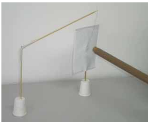
Figura 77: A penugem está presa à linha de seda ( i.e. , isolante elétrico), ao fundo temos o anteparo de papel sulfite aterrado e à frente a cortiça fixada ao tubo de PVC atritado com poliamida.
