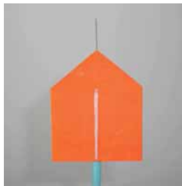
(b) A Figura apresenta em detalhe o instrumento elétrico em forma de “casinha” com haste metálica na extremidade superior, tirinha de papel de seda ao centro e canudinho de refresco para o suporte.
