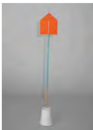
(a) A Figura apresenta o instrumento elétrico em forma de “casinha” com haste metálica na extremidade superior, tirinha de papel de seda ao centro e canudinho de refresco preso a um suporte com base de gesso.
