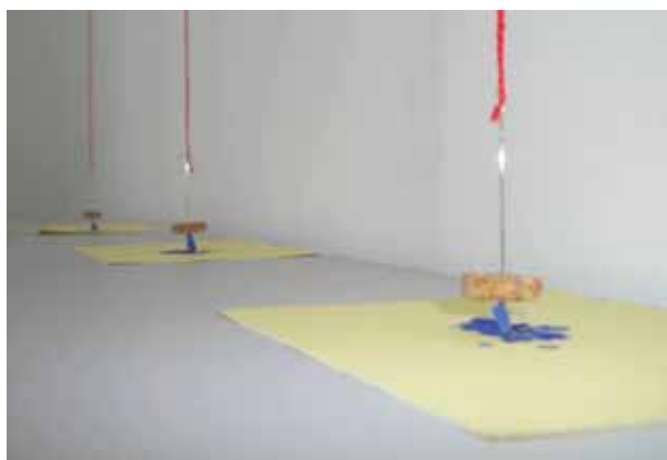
Figura 93: Os três discos de cortiça presos a linhas de algodão por meio de agulhas de costura atraindo pedacinhos de papel de seda colocados sobre um pedaço de papel sulfite após a eletrização do tubo de PVC por meio de atrito com poliamida.
