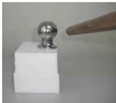
Figura 196: Tubo de PVC atritado sendo aproximado da bola de metal fixada em uma base de isopor.
