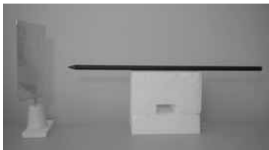
Figura 199: À esquerda está o anteparo de papel alumínio sobre uma base de isopor, e à direita uma barra de ferro sobre uma base de isopor, a qual é formada por duas peças de isopor.
