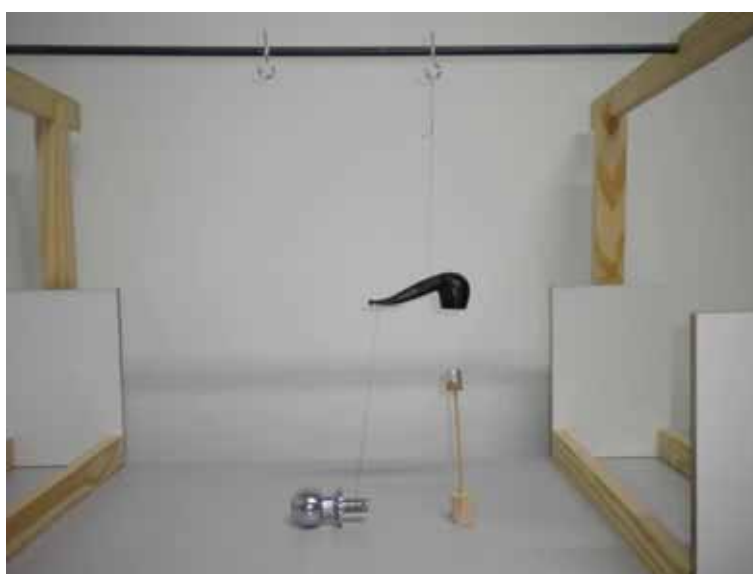
Figura 108: Cachimbo suspenso por linhas de seda, abaixo do forninho há uma rolha de cortiça presa a um palito e pequena base de madeira.
