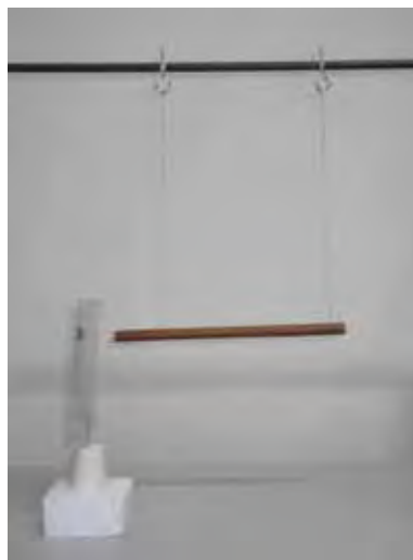
Figura 207: À esquerda há um anteparo de papel alumínio sobre uma base de isopor; à direita há uma vara de madeira suspensa por linhas de seda fixadas na haste horizontal de um suporte de madeira.
