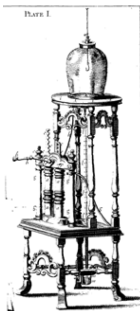
Figura 132: Gravura da bomba de ar desenvolvida por Francis Hauksbee. Extraída de (HAUKSBEE, 1709).
