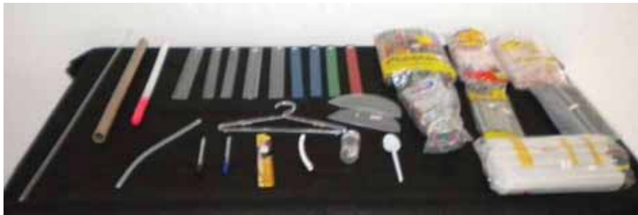
Figura 10: Materiais utilizados para teste de eletrização: 7 tipos diferentes de canudo de refresco; 9 réguas escolares diferentes; cano (tubo) de PVC (50 cm de comprimento e 25 mm de diâmetro); pente de plástico; tubo de plástico (brinquedo); cabide de plástico; pote de sal de plástico duro; porta papel de plástico; regulador de cortina persiana de plástico; bastão de resina de cola quente; mangueirinha de plástico; colher de plástico; duas canetas com tubinhos de plástico de marcas diferentes.
