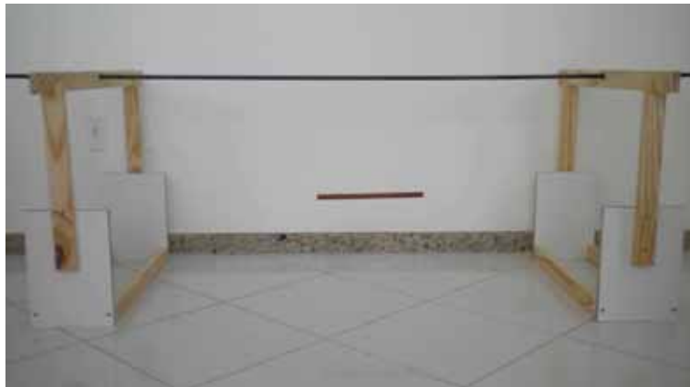
Figura 203: Suporte de madeira com haste horizontal de ferro e uma vara de madeira pendurada por meio de linhas de poliamida.
