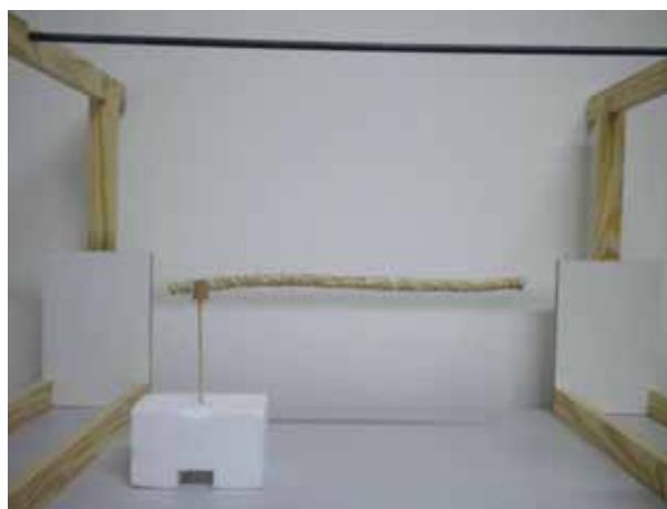
Figura 171: A figura apresenta um pedaço de corda preso por linhas de poliamida (linhas de pesca) à haste horizontal de ferro do suporte de madeira e uma rolha de cortiça presa a uma vareta de madeira fixadas a um pedaço de isopor. A cortiça e a corda não estão encostadas.
