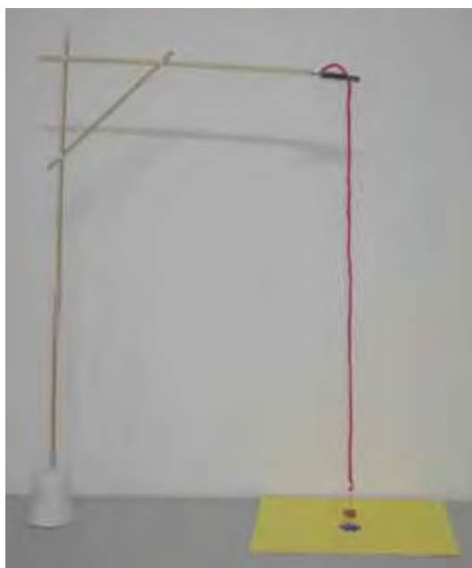
Figura 94: Aparato completo utilizado para o experimento em que há transporte de eletricidade sem que o tubo toque a linha de transmissão. Há um suporte de madeira feito com palitos de churrasco e base de gesso, uma linha de seda pendurada verticalmente ao suporte por meio de uma garra "tipo boca de jacaré" e, preso à extremidade inferior da linha, um disco de cortiça fixado por meio de uma agulha.
