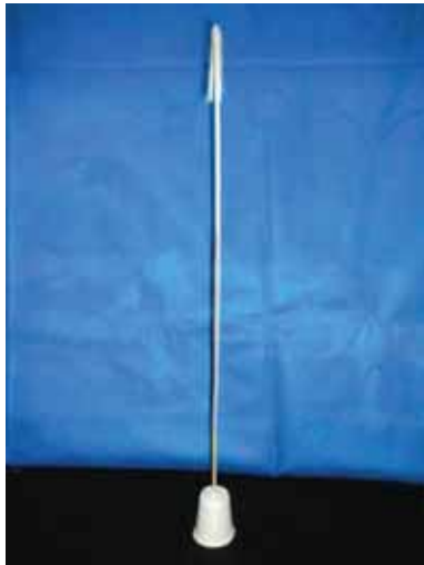
(a) Aparato completo antes da aplicação do tubo atritado. Na parte inferior há um poste de sustentação, no meio um canudo plástico utilizado para isolar a parte superior, acima do canudo temos o palito de madeira com a estrela na sua ponta de cima.
