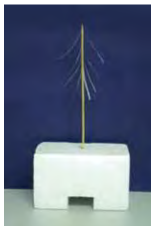
(b) Aparato após contato do tubo de PVC eletrizado com poliamida na ponta do palito de madeira.
