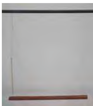
Figura 167: Em detalhe a figura apresenta a vareta de madeira horizontal presa por linhas de poliamida (linhas de pesca) na haste horizontal de ferro do suporte de madeira e a vareta vertical presa por linha de seda à mesma haste.
