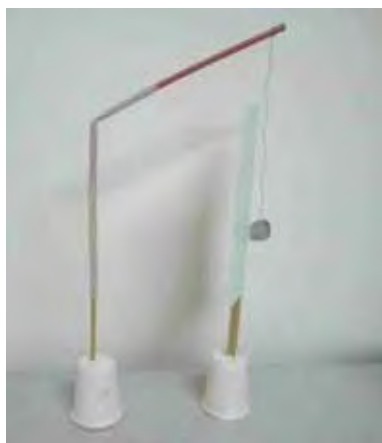
(a) Pêndulo com papel sulfite. O papel sulfite está aterrado pois a base é de gesso e palito de madeira.
