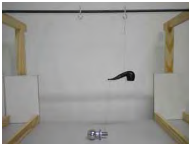
Figura 104: Aparato utilizado para suspender o cachimbo de madeira. Ao alto da figura há uma haste horizontal presa à dois suportes laterais de madeira. O cachimbo, ao centro da figura, está suspenso por uma linha isolante de seda presa à haste horizontal. Uma segunda linha de seda, presa à piteira, o prende em uma peça de ferro colocada sobre a mesa, para que o cachimbo fique na posição correta.
