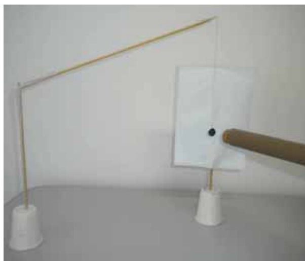
Figura 78: O disco de papel de seda (material condutor) está preso à linha de seda ( i.e. , isolante elétrico). Ao fundo temos o anteparo de papel sulfite aterrado e à frente a cortiça fixada ao tubo de PVC atritado com poliamida.
