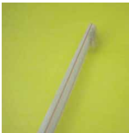
Figura 30: Penugem grudada no canudo atritado sendo atraída por uma folha de papel sulfite amarelo à distância aproximada de 1 cm. Neste experimento a penugem não se desgrudou do canudo.
