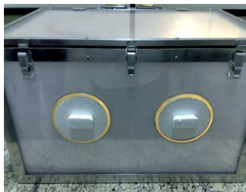
Figura 8 - Cabine com (37\pm 1) °C e UR 95-100%
