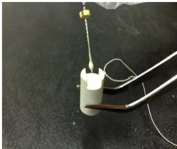
Figura 10 – Preparo das amostras para estudo de liberação de íons
