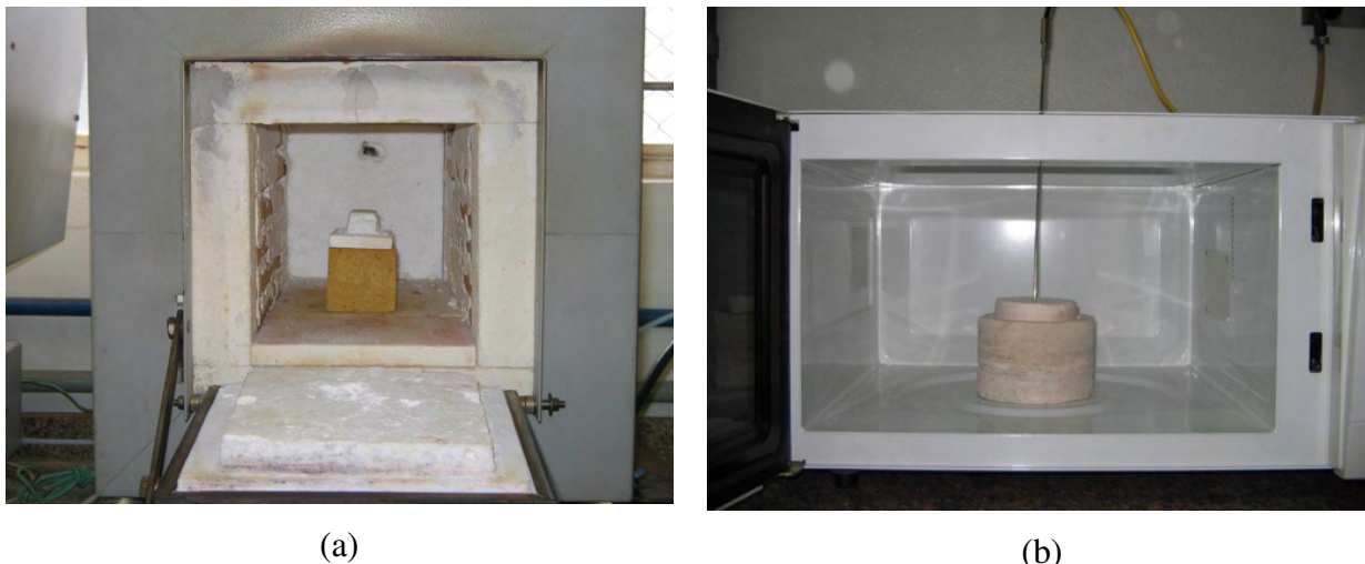
Figura 6 - Forno convencional (a) e microondas (b) para sinterização dos compactos cerâmicos.
