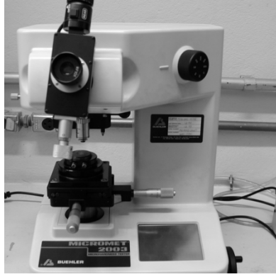
Figura 12. Equipamento MICROMET 2003 – BUEHLER utilizado para o ensaio de microdureza Vickers.
