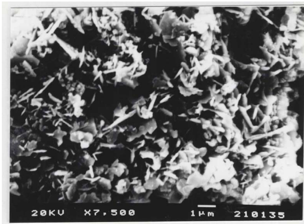
Figura 69: Micrografia eletrônica de varredura das amostra CS-75.1 calcinada a 950°C.
