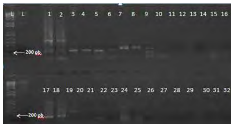
Figura 1 – Corrida em gel de agarose 1,5 %, corado com Brometo de Etídeo - Resultados de PCR primers de microsatélites para Perdizes 60° C. A distribuição das amostras segue a seguinte ordem: L - ladder de 1kb; 1 e 2 - primer 8A; 3 e 4 - primer 12A ; 5 e 6 - primer 12B; 7 e 8 - primer 09D; 9 e 10 - primer 10D; 11 e 12 - primer 09C; 13 e 14 - primer 03D; 15 e 16 - primer 11D; 17 18 - primer 04F; 19 e 20 - primer 10F, 21 e 22 - primer 12F; 23 e 24 - primer 03G; 25 e 26 - primer 06G; 27 e 28 - primer 11G; 29 e 30 - primer 12G e 31 e 32 - primer 05H.
