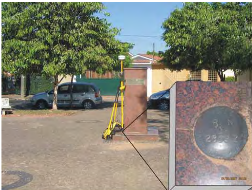
Foto 1.1 Detalhe da placa da estação altimétrica IBGE número 2859Z localizada no município de Rio Claro – S.P.
