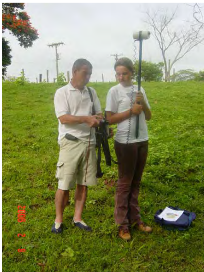
Foto 5.7 Magnetômetro móvel ( Rover ) usado na aquisição dos pontos magnetométricos
