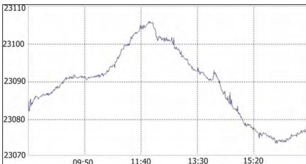
Figura 5.7 Exemplo da variação diurna do campo magnético adquirido pelo magnetômetro base em um levantamento realizado na área de estudo. No eixo X os horários de cada medida e no eixo Y as leituras obtidas em nT.
