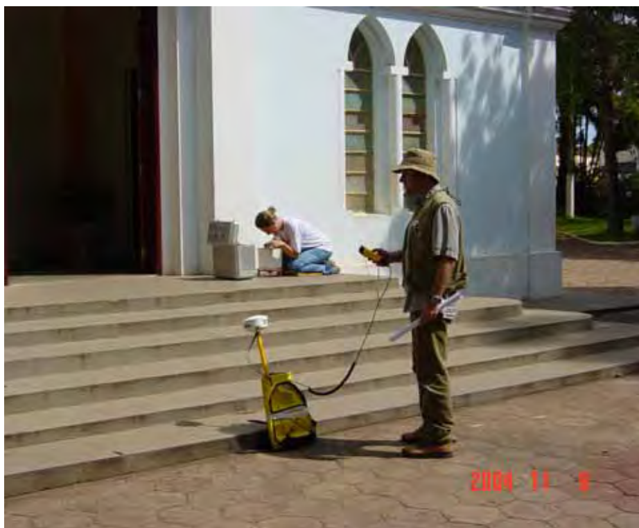
Foto 5.5 Preparativos para a aquisição de dados com o GPS Pathfinder Pro-XR da Trimble.
