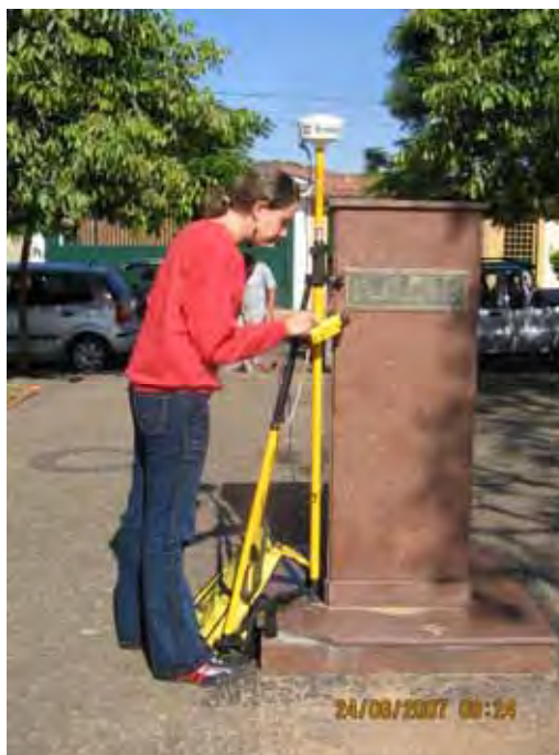
Foto 1.2 Aquisição altimétrica com o GPS Pathfinder Pro XR na estação altimétrica IBGE número 2859Z localizada no município de Rio Claro – S.P.
