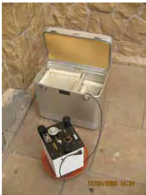
Foto 5.2 Gravímetro La Coste Romberg utilizado na aquisição das estações gravimétricas deste estudo.
