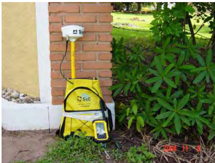
FOTO 5.4 GPS Pathfinder Pro-XR e coletor de dados da Trimble Navigation Limited.
