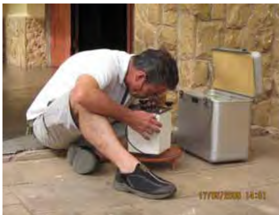
Foto 5.3 Leitura do gravímetro nas aquisições das estações gravimétricas em campo.
