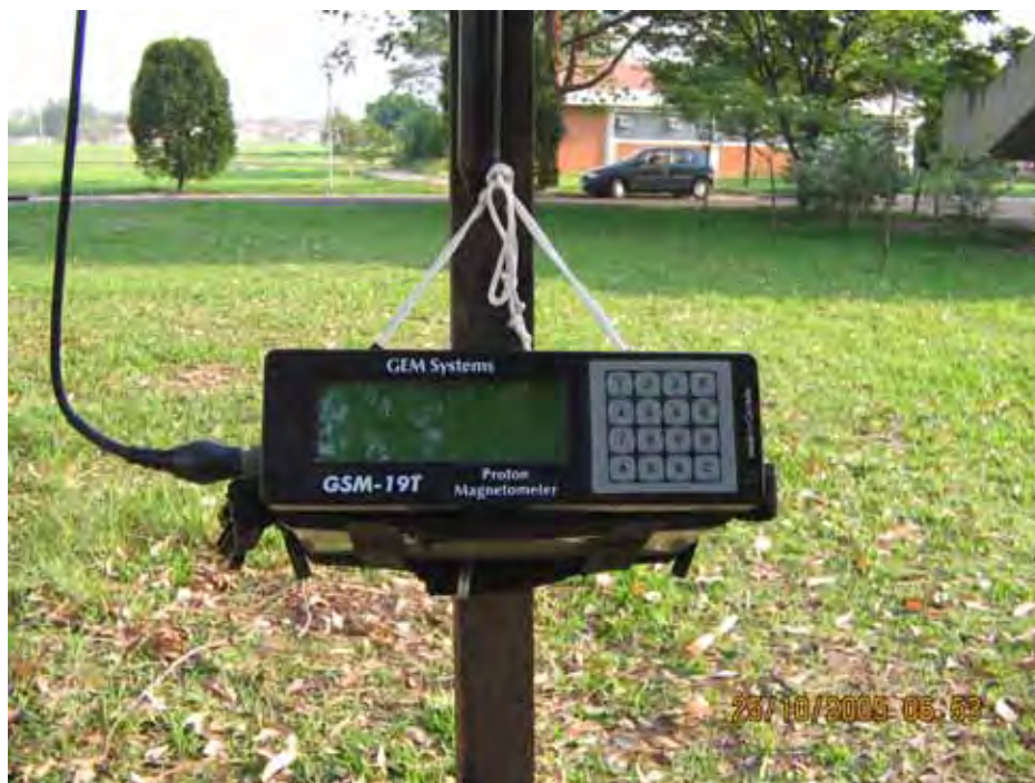
Foto 5.6 Magnetômetro de base da GEM Systems usado no estudo.
