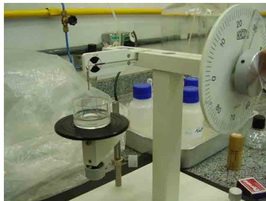
Figura 3.10 – Tensiômetro Krüss K6
