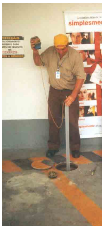
Figura 3.2 - Coleta de amostra de água subterrânea com amostrador bailer descartável (posto SB).
