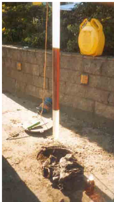
Figura 3.9 – Fase livre (óleo diesel) na água subterrânea do posto ASP
