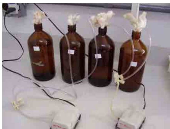
Figura 3.8 – Experimento com água subterrânea (condição aerada)
