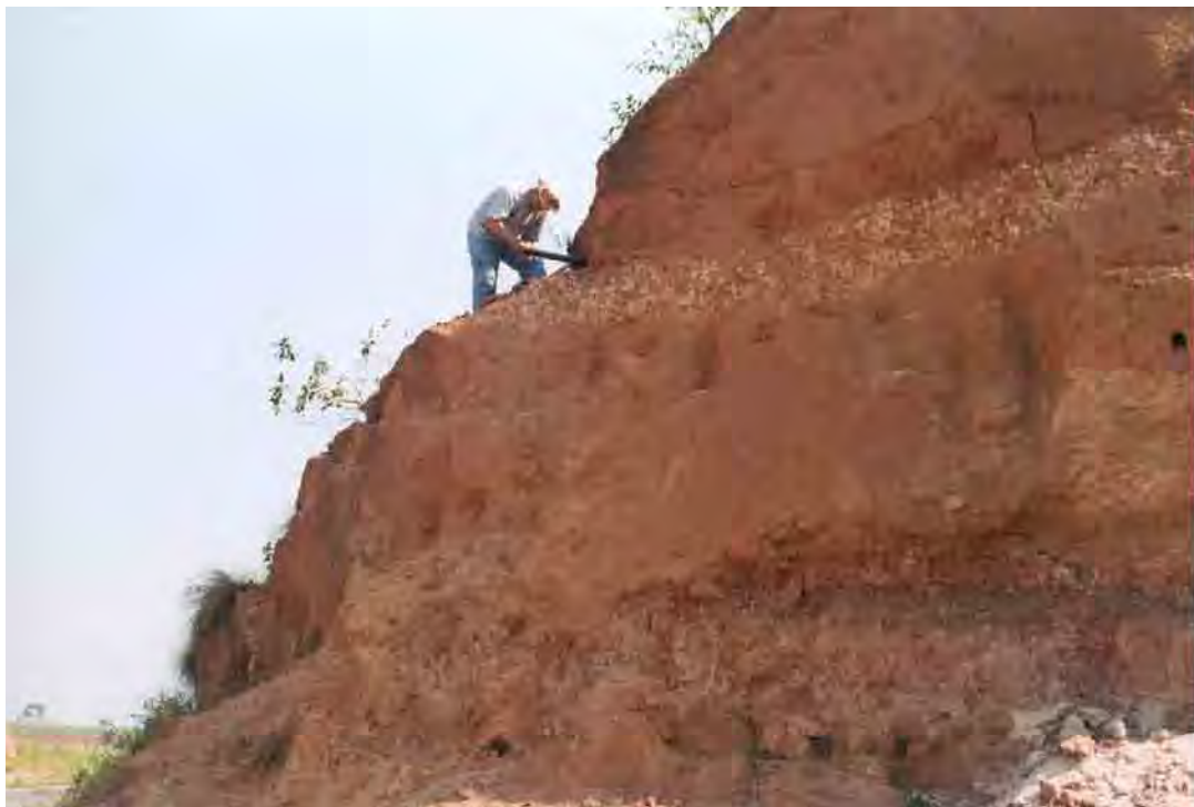
Foto 1. Amostragem para TL, utilizando tubo de PVC.
