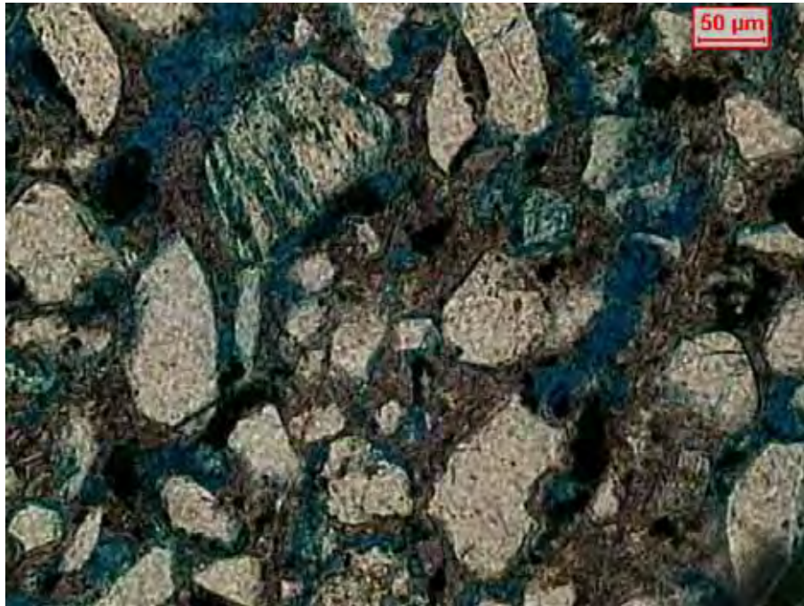
Foto 6.17. Dissolução de grãos de feldspato, e presença de argilas formando matriz ao redor dos grãos do arenito (Amostra CAM002 Nicóis //).
