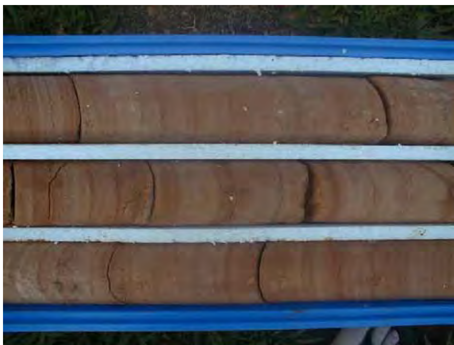
Foto 2.4. Testemunho obtido na sondagem efetuada em Camapuã (MS), em zona de afloramento dos arenitos da Formação Botucatu.
