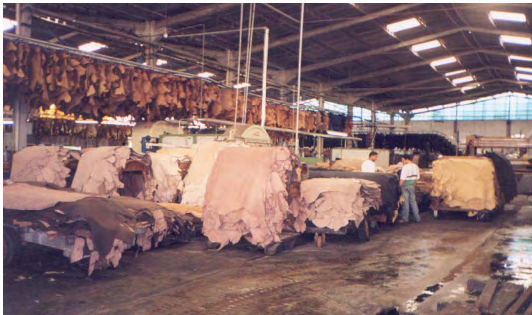
Fig. 3 Secagem, Curtume Tropical, Franca/SP.
