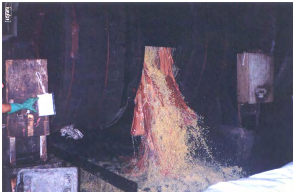
Fig. 2 Recurtimento no fulão, Curtume Finipelli, Patrocínio Paulista/SP.
