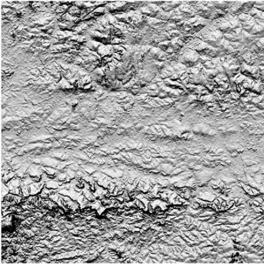
(B): Imagem relevo sombreado com 70° de elevação da fonte de iluminação, azimute 90° e 5x de exagero vertical
