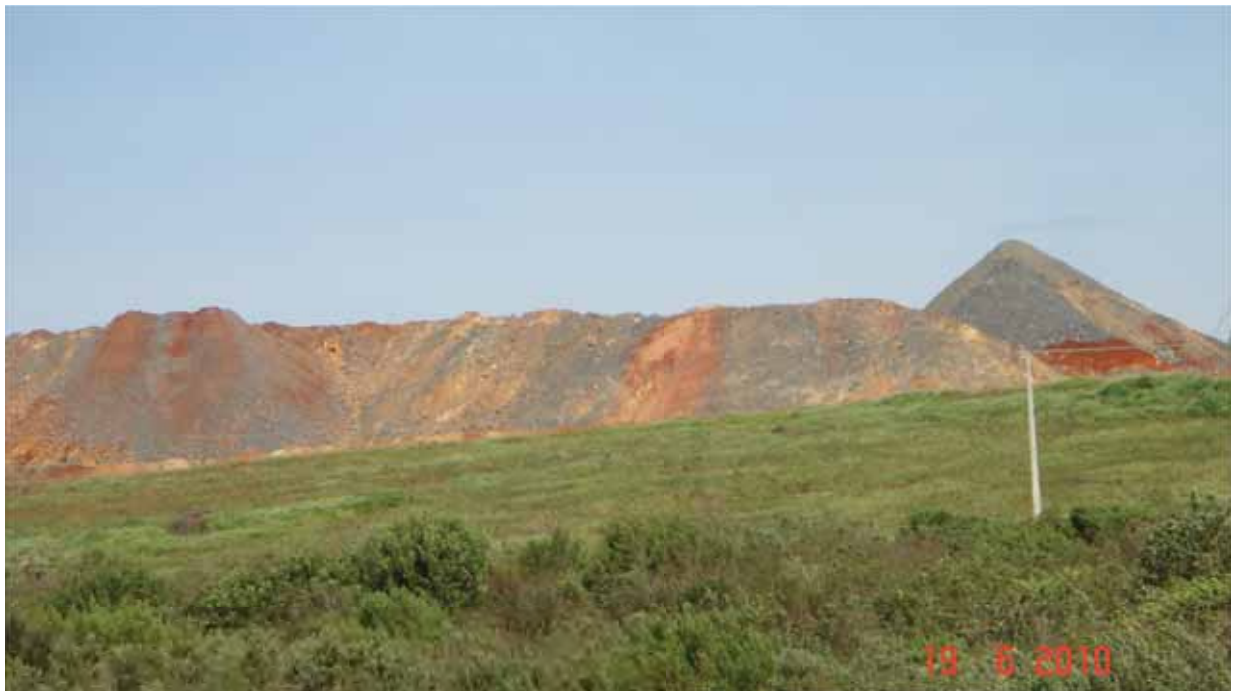
Figura 22 - Disposição temporária do solo vegetal retirado durante o decapeamento da Mina Dois Irmãos.
