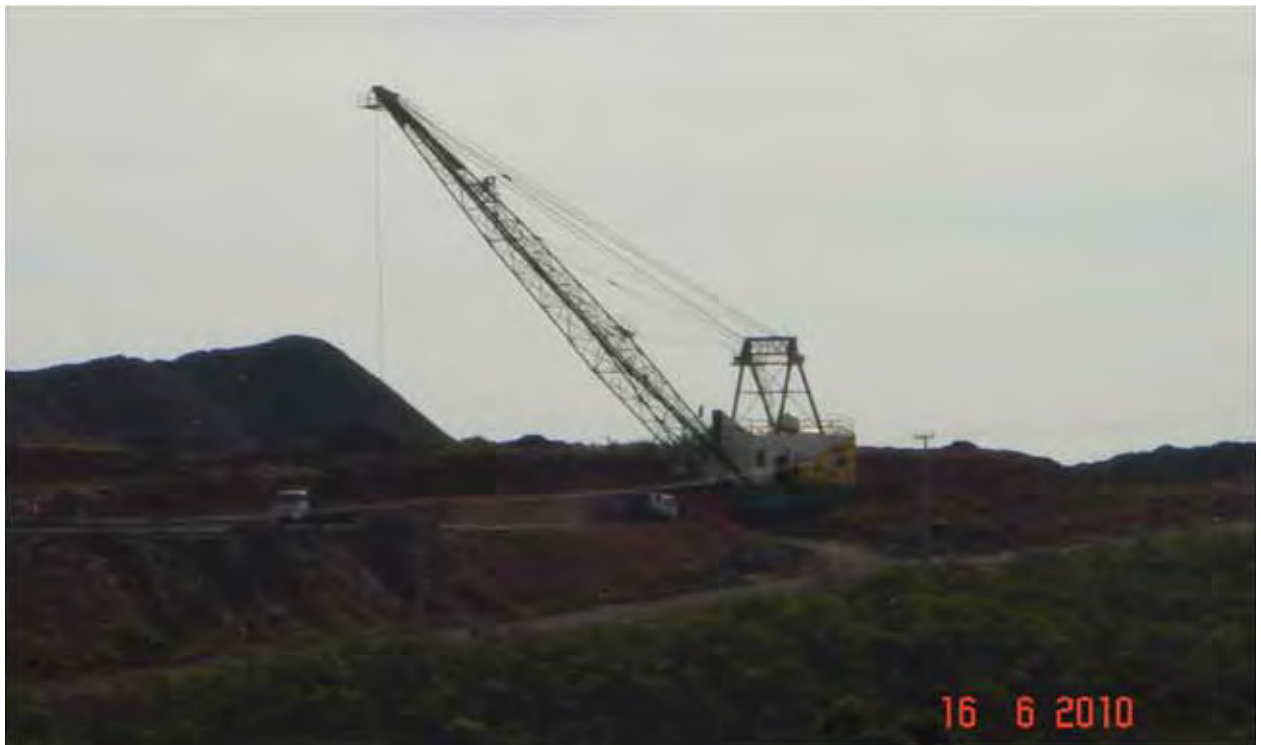
Figura 21 - Decapeamento da jazida de folhelho pirobetuminoso da Formação Irati.
