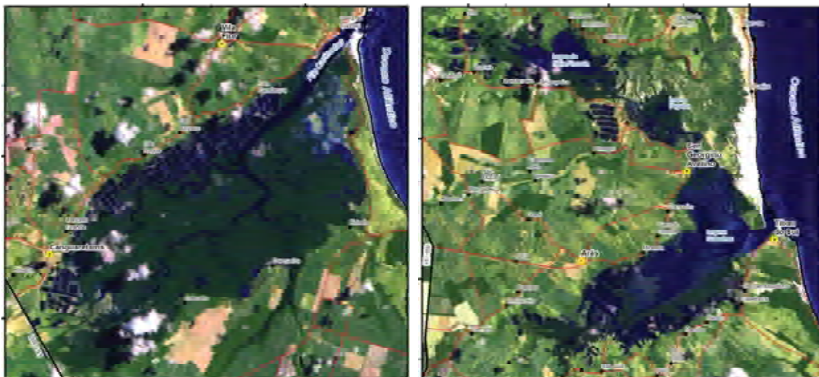
Figura 48 - Fragmentos da imagem do sensor TM do satélite Landsat 5, com composição de bandas espectrais 7R5G3B, utilizadas no levantamento dos impactos ambientais em manguezais, com destaque aos estuários do Curimataú e Nísia-Papeba-Guaraíras. Imagem de 06/09/2010 .
