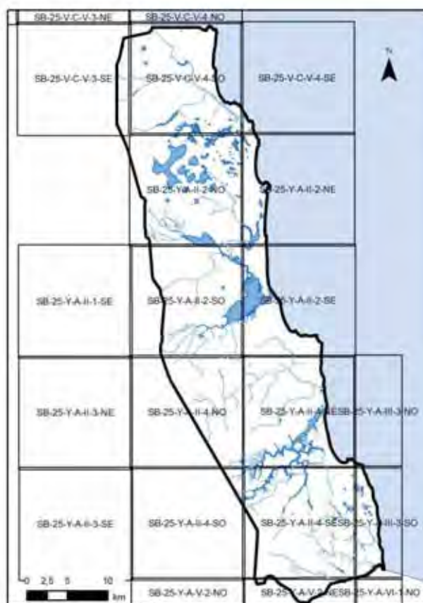
Figura 45 - Mapa-índice considerando o levantamento aerofotogramétrico SETUR/SIN/IDEMA (2006) na articulação pela nomenclatura IBGE. Mapeamento base em escala de 1:25.000, associada à área de estudo.
