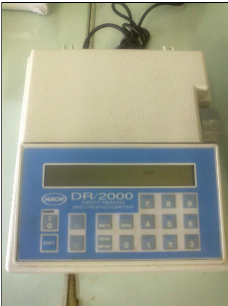
Figura 10: Aparelho DR/2000 para as análises dos cátions e ânions.
