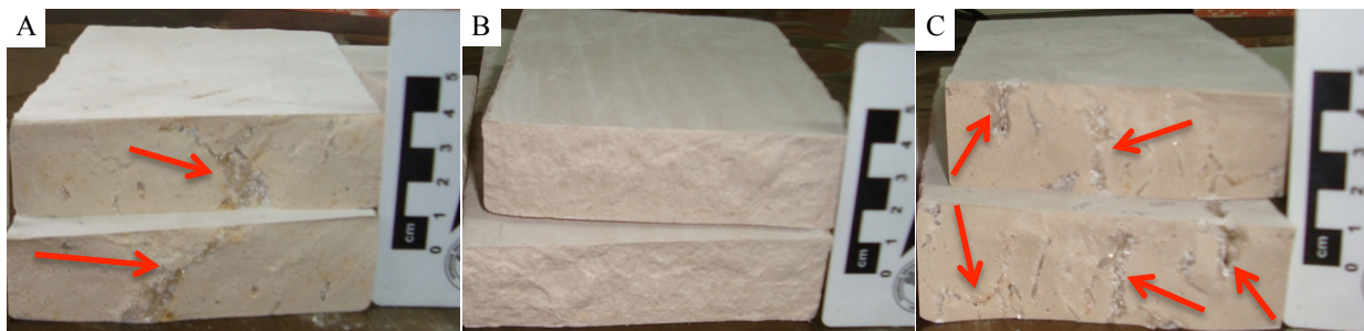
Figura 6.10 – Superfícies de rupturas dos corpos de prova após realização do ensaio de flexão pelo método 4 pontos
