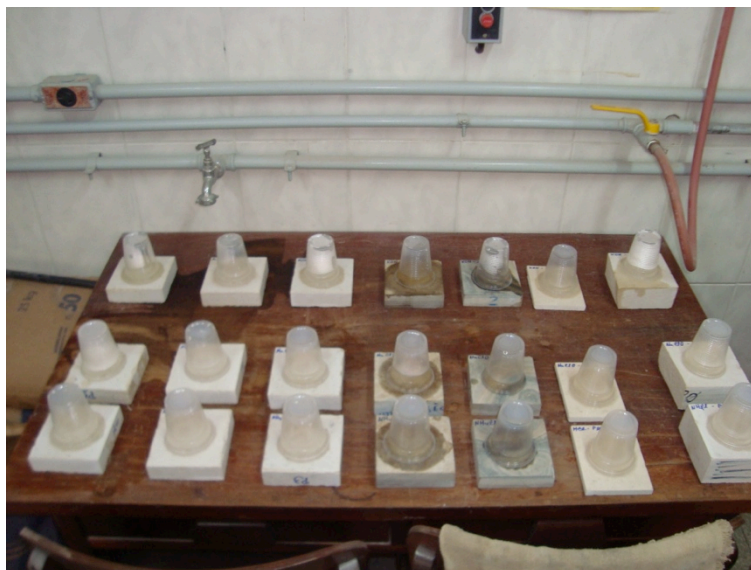
Figura 8.1 – Aplicação dos reagentes nas placas utilizando copos descartáveis.
