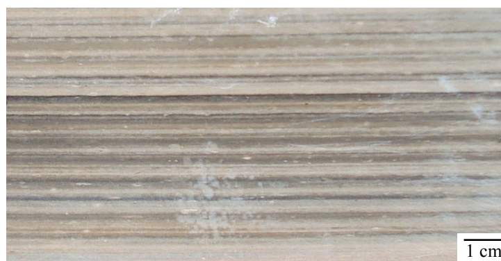
Legenda: Calcário com laminação dada pela alternância entre bandas claras e escuras. As bandas escuras se caracterizam pela maior concentração de minerais opacos.
