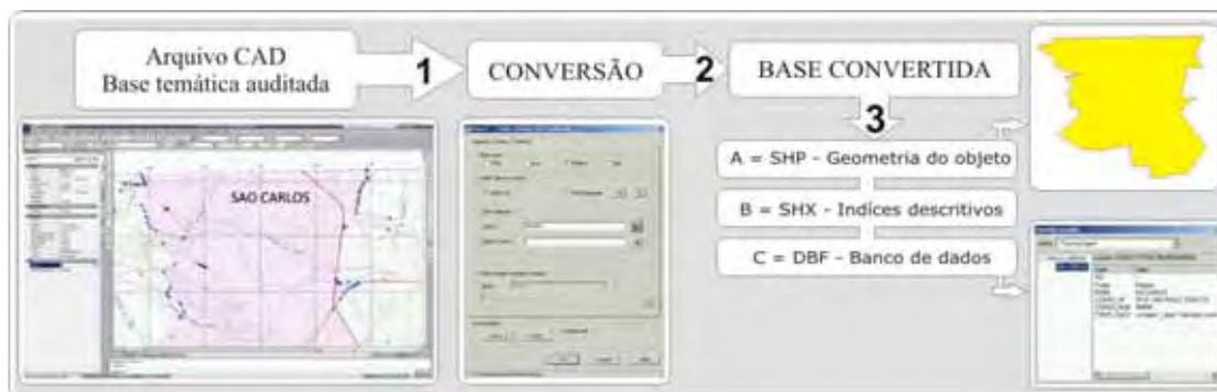
Figura 3.4 - Resumo do processo de conversão. Neste processo a base convertida, demonstrada nas figuras anteriores, gera a partir de um arquivo CAD (1) três arquivos de formatos distintos e que são utilizados no SIG. Os arquivos gerados estão em formatos SHP(3), SHX (3) e DBF (3).
