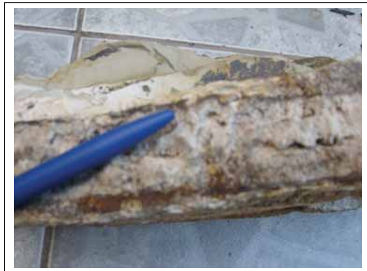
Figura 35 – Foto da rocha de calcário incrustado em fratura utilizado como aditivo.
