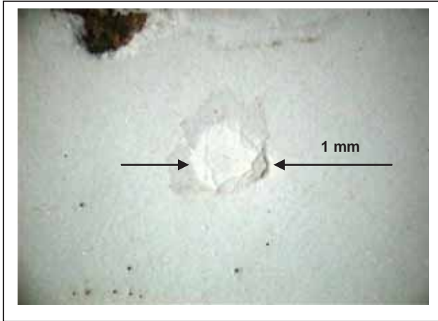
Figura 50 – Foto da microtrinca circular irregular na camada de esmalte, produzido por contaminação de calcário incrustado.
