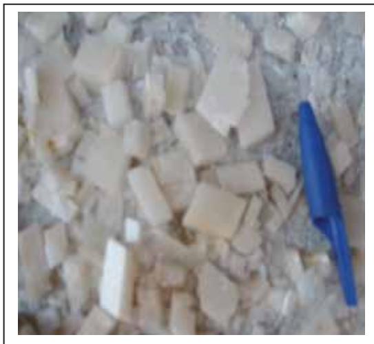
Figura 61 – Foto da calcita cristalina de veio utilizada na aditivação de massa cerâmica – teste 5
