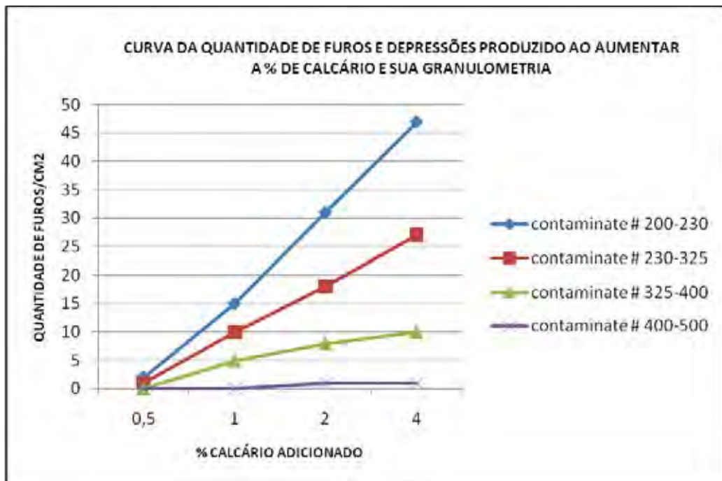
Figura 54 – Curva comparativa da quantidade de furos e depressões ocorridas nas amostras compostas por massa utilizada nas indústrias cerâmicas da região de Santa Gertrudes aditivadas com calcário incrustado nas porcentagens de 0,5 %, 1,0%, 2,0%, e 4,0% e nas granulometrias referentes ao intervalo das malhas 200#-230#, 230#-325#, 325#-400# e 400#-500# (ABNT).
