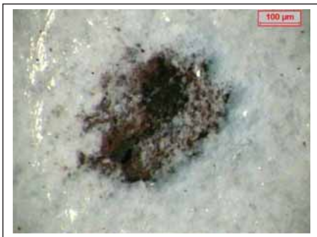
Figura 40 – Foto microscópica do furo em peça esmaltada contaminada propositalmente com calcário com granulometria 35#-40# ABNT na proporção de 10% na massa.
