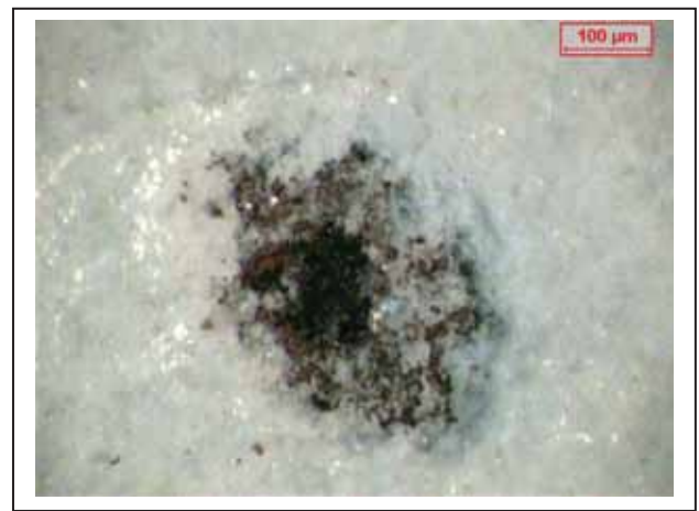
Figura 41 – Foto microscópica do furo em peça esmaltada contaminada propositalmente com calcário com granulometria superior a 35#-40# ABNT na proporção de 5 % na massa.
