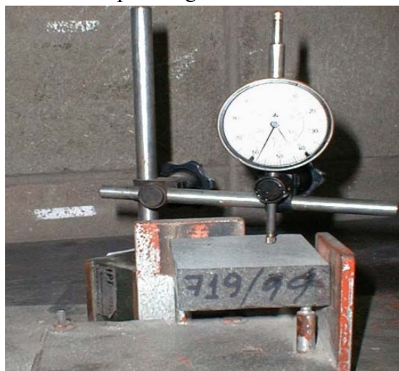
Figura 8. Medição do corpo-de-prova com relógio comparador, antes e após o desgaste.
