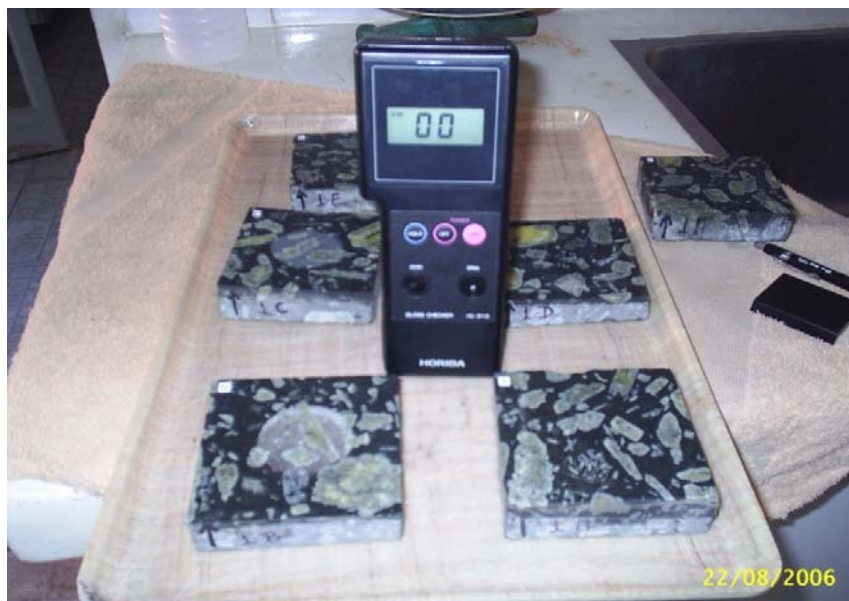
Figura 5. Ensaio que simula a alterabilidade induzida pelos processos naturais antropogênicos e de degradação sobre Diabásio porfirítico. No centro o aparelho Gloss Meter usado para medir perda de brilho.
