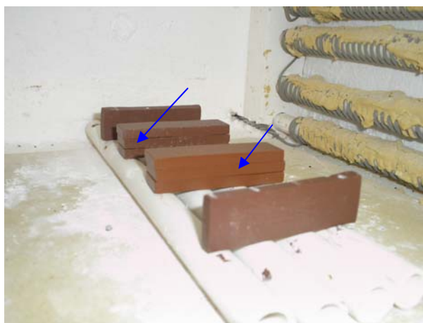
Figura 17. Queima dos corpos-de-prova para a análise de coração negro. Setas azuis indicando os corpos analisados.
