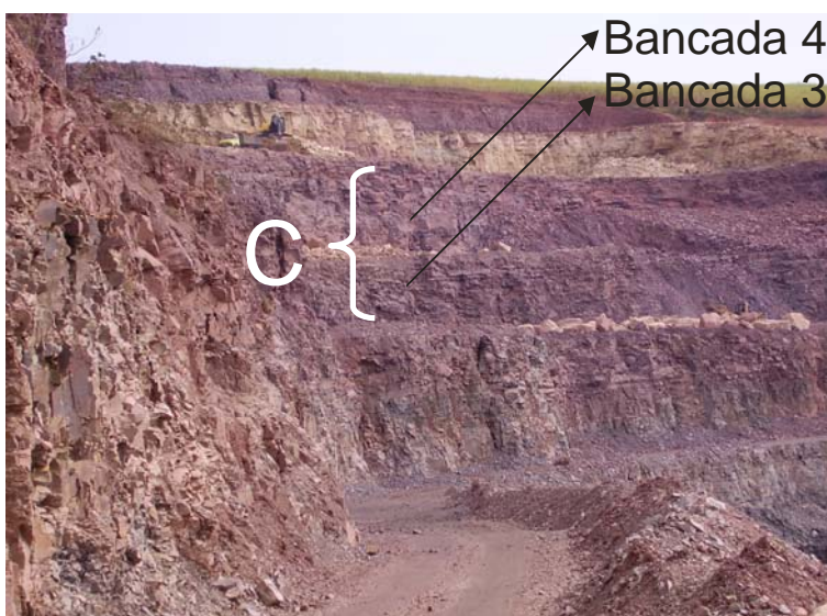
Figura 15. Vista geral de bancadas pertencentes à Formação Corumbataí da mina Cruzeiro com indicação das bancadas 3 e 4 que formam a amostra C. A mina Cruzeiro explora as Formações Irati e Corumbataí. A Formação Irati é sobreposta de forma concordante pela Formação Corumbataí. A bancada de transição entre as formações é descartada. Outras quatro bancadas (incluindo as 3 e 4) da Formação Corumbataí totalizam aproximadamente 35 metros de altura e são fontes de matéria-prima da indústria de revestimento cerâmico.
