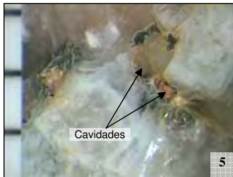
Fotografias 5 e 6: Detalhe de lamelas de biotita corroídas, formando material argiloso amarelado e cavidades.
