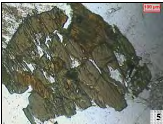
Fotomicrografia 5 - Cristal de anfíbólio subédrico apresentando transformações para biotita entre as clivagens, nas regiões centrais e bordas. Nicóis paralelos.
