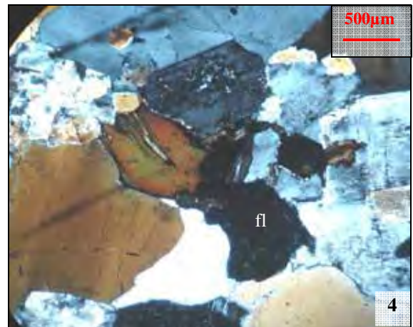
Fotomicrografia 3 - Cristal de biotita subédrico e intercrescido com fluorita, notar limites dos cristais (quartzo e feldspato) bem delimitados e alterações para argilo mineral no feldspato. Nicóis paralelos.
