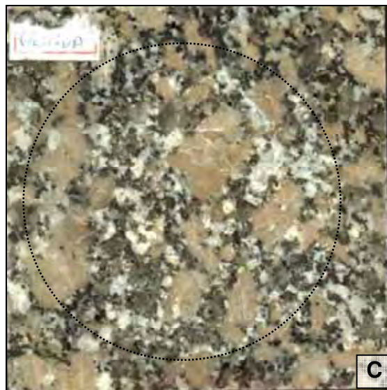
PRANCHA 9.4 - Granito Rosa Olinda: A - placa não atacada, B - ataque com ácido cítrico e C - ataque com ácido clorídrico, cujas reações nos minerais causam mudança na coloração, gerando aspecto desbotado com manchas esbranquiçadas e amareladas de oxidação na placa. Com ácido cítrico as reações são menos nítidas. Escala em centímetros.
