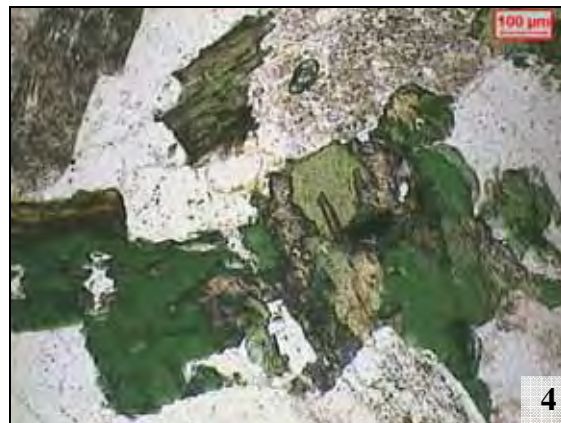
Fotomicrografia 3 - Agregado de biotita associada com allanita metamicta e fluorita intersticial (porção central inferior). Canto esquerdo biotita alterada para clorita com faixas marrom e verde. Nicóis //.
