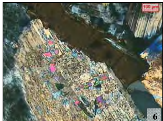
Fotomicrografia 5 – Plagioclásio com lamelas de mica branca envolvendo biotita cloritizada com inclusões de zircão e bordas corroídas. Nicóis cruzados.
