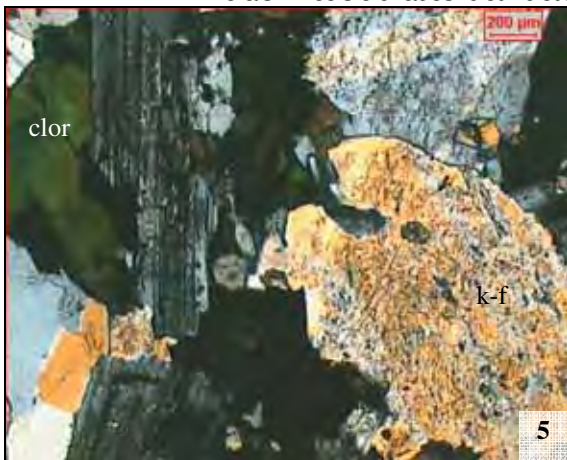
Fotomicrografia 5 - Cristal de clorita envolvendo plagioclásio (albita) com lamelas de mica branca e feldspato potássico alterado para argilo minerais. Nicóis cruzados. clor = clorita, k-f = feldspato potássico
