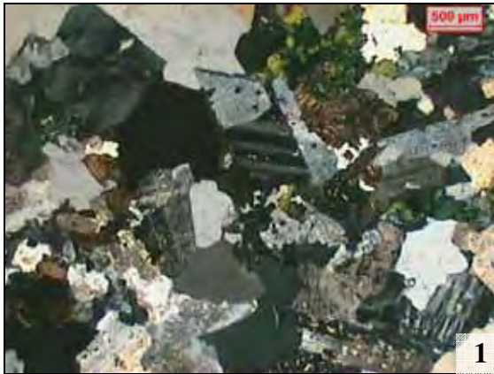
Fotomicrografia 1 - Aspecto geral da matriz quartzo-feldspática com biotita cloritizada (porção superior direita). As lamelas de mica branca estão mais desenvolvidas nos feldspatos próximos aos cristais de biotita. Nicóis cruzados.
