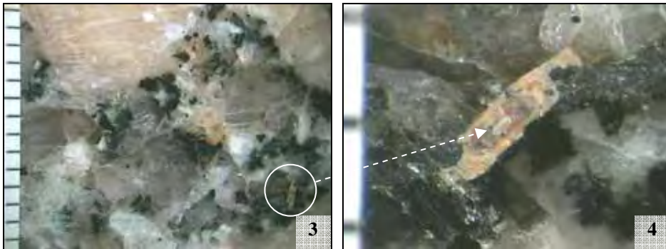
Fotografia 3: Feldspato potássico com pontos brancos formados por microinclusões de plagioclásio alterado para material argiloso, biotitas levemente corroídas e contatos dos cristais preenchidos por fina camada de material argiloso .
