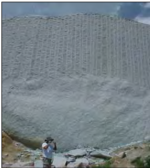
Fotografias 5.3: Desenvolvimento da lavra em matacões com baixo fraturamento que permite a divisão do bloco em pranchas, paralelas ao plano de melhor corte, visto que, em função da homogeneidade do granito, não existe um plano preferencial de corte.
