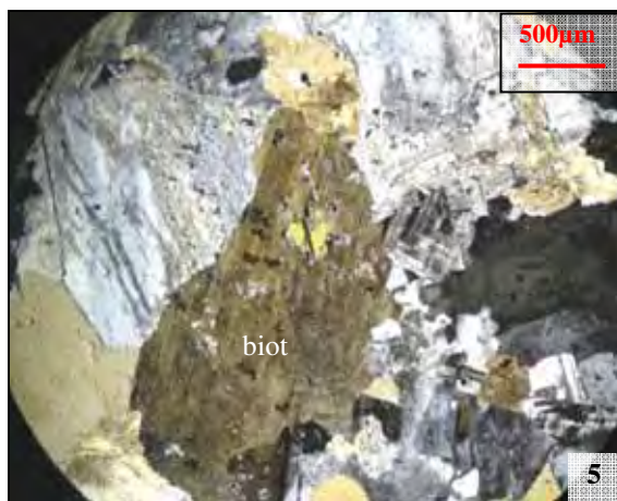
Fotomicrografia 5 - Cristal de biotita alterado para mica branca e argilominerais, notar aspecto turvo dos feldspatos. Nicóis cruzados. biot = biotita
