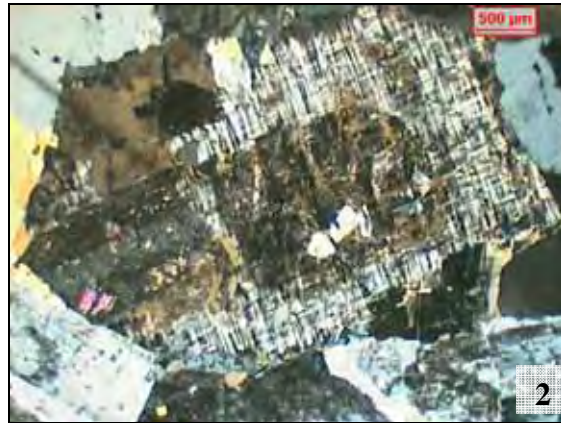
Fotomicrografia 1 - Feldspato potássico exibindo linhas de crescimento marcadas por argilominerais e óxidos de ferro . Nicóis cruzados.
