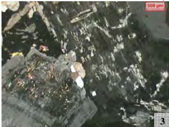
Fotomicrografia 3 – Microclínio com pertitas albitizadas e cristal de plagioclásio zonado com núcleos alterados para argilominerais e mica branca. Nicóis cruzados.
