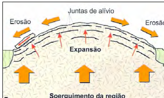
Figura 4.6 – Esquema de expansão volumétrica de corpos graníticos formando as juntas em resposta ao alívio de pressão litostática por meio de soerguimento e erosão. Fonte: Teixeira (2000).
