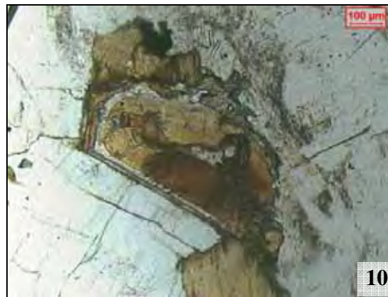
Fotomicrografia 9 - Biotita associada a cristal de allanita subédrico com núcleo metamictizado e com pequenos prismas de apatitas euédricas. Nicóis descruzados.
