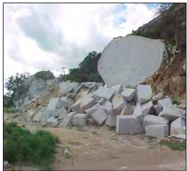
Fotografias 5.3: Desenvolvimento da lavra em matacões com baixo fraturamento que permite a divisão do bloco em pranchas, paralelas ao plano de melhor corte, visto que, em função da homogeneidade do granito, não existe um plano preferencial de corte.
