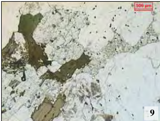
Fotomicrografia 9 - Biotita cloritizada com bordas corroídas associada com fluorita intersticial bem desenvolvida. Nicóis paralelos.
