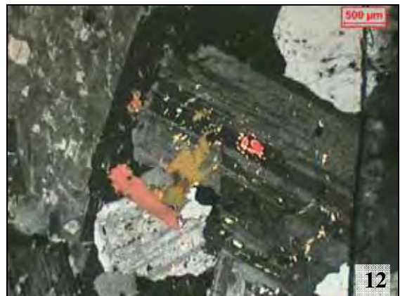
Fotomicrografia 11 - Detalhe da fotomicrografia (6), acima; notar a presença de argilominerais e de minerais opacos intercalados às lamelas de mica branca. Nicóis cruzados.
