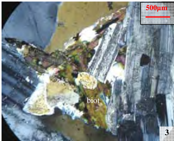
Fotomicrografia 3 - Cristal de biotita alterado para muscovita (cor de interferência) e plagioclásio com argilo minerais. Notar bordos corroídos da biotita alterada. Nicóis cruzados. biot =biotita
