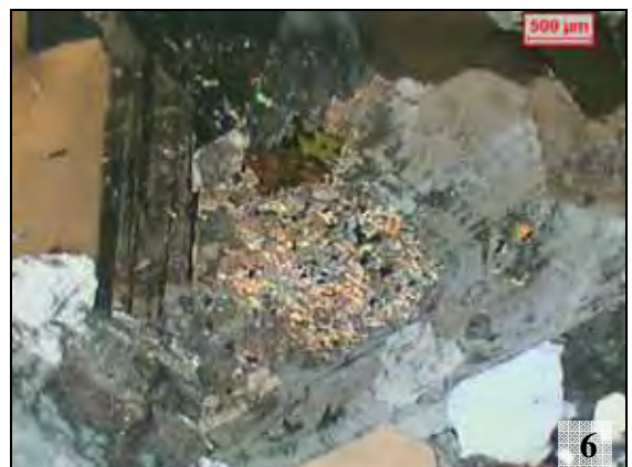
Fotomicrografia 5 - Plagioclásio com intensa substituição para mica branca no núcleo. A presença da biotita intensifica a alteração para mica branca nos cristais no seu entorno. Nicóis cruzados.
