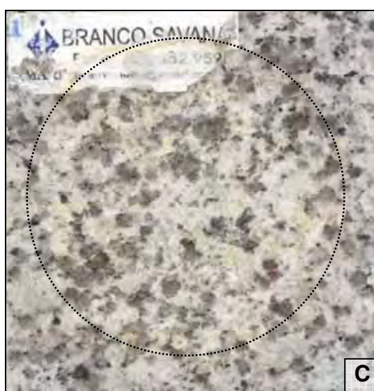
PRANCHA 9.5 - Granito Branco Savana: A - placa não atacada, B - ataque com ácido cítrico e C - ataque com ácido clorídrico, cujas reações nos minerais causam mudança na coloração, gerando aspecto desbotado com manchas esbranquiçadas e amareladas. No ataque com ácido cítrico as reações são menos nítidas. Escala em centímetros.
