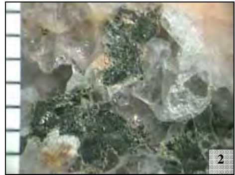
Fotografia 1: Zoneamento do plagioclásio com material argiloso amarelo, provenientes da alteração da biotita, que mostra-se intensamente corroída com material argiloso e microfissuras do quartzo.
