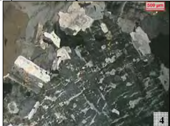
Fotomicrografia 3 – Microclínio com pertitas albitizadas e cristal de plagioclásio zonado com núcleos alterados para argilominerais e mica branca. Nicóis cruzados.
