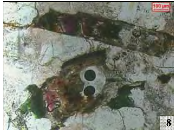
Fotomicrografia 7 - Cristal de allanita euédrica metamictizada, circundada por apatita microfissurada com planos dispostos em direções perpendiculares e preenchidas por opacos disseminados e óxidos de ferro. Porção superior e esquerda da seção com cristais de plagioclásio argilizados e com presença de óxidos/hidróxidos de ferro. Nicóis paralelos.
