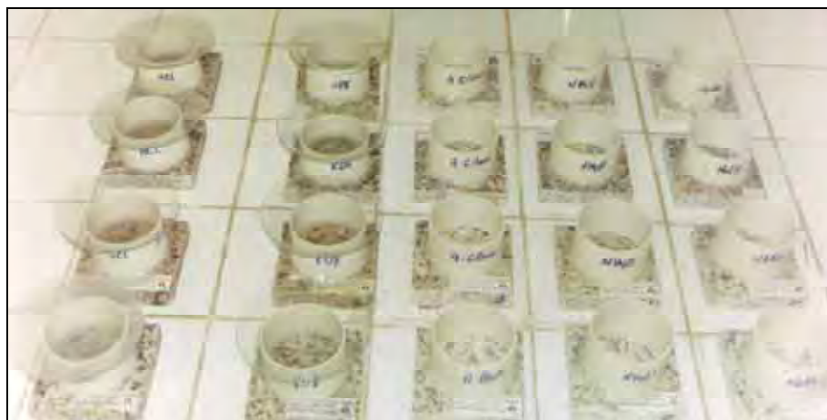
Fotografia 9.2 Visão geral das amostras durante o ensaio de ataque químico dos quatro tipos graníticos (dispostos em linhas) em contato com os cinco reagentes (fotografia obtida após 24 horas de ensaio).
