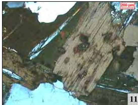
Fotomicrografia 11 - Biotita com bordas corroídos e inclusões de zircão, epidoto (no centro ) e opacos disseminados. Nicóis cruzados.
