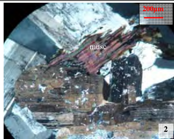
Fotomicrografia 1 - Cristais de biotita cloritizada (com oxido de ferro) envolvendo cristal de plagioclásio alterado para argilo minerais. Nicóis cruzados. clor = clorita
