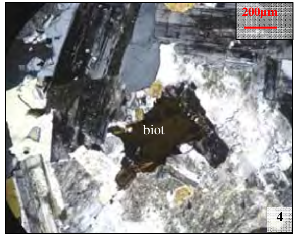
Fotomicrografia 3 - Cristal de biotita alterado para muscovita (cor de interferência) e plagioclásio com argilo minerais. Notar bordos corroídos da biotita alterada. Nicóis cruzados. biot =biotita
