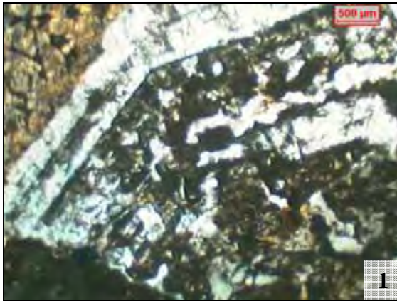
Fotomicrografia 1 - Feldspato potássico exibindo linhas de crescimento marcadas por argilominerais e óxidos de ferro . Nicóis cruzados.
