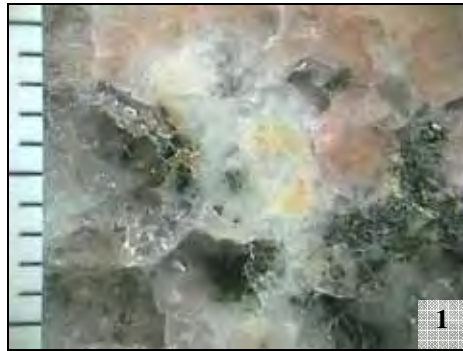
Fotografia 1: Zoneamento do plagioclásio com material argiloso amarelo, provenientes da alteração da biotita, que mostra-se intensamente corroída com material argiloso e microfissuras do quartzo.
