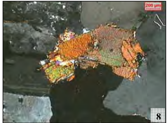
Fotomicrografia 7 – Biotita parcialmente alterada com finas franjas de mica branca nas bordas. À esquerda cristal de muscovita e lamelas de mica branca inclusos no feldspato. Nicóis cruzados.
