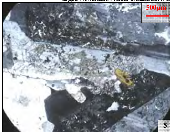
Fotomicrografia 5 - Cristal de plagioclásio zonado com pequenas lamelas de mica branca e alterado para argilo minerais com inclusão de biotita cloritizada. Nicóis cruzados.
