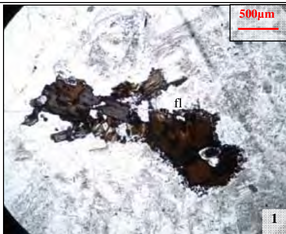
Fotomicrografia 1 - Cristais de biotita subédrica, notar contornos irregulares e “esfiapados”. Nicóis paralelos.
