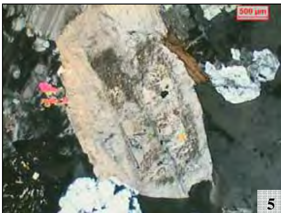
Fotomicrografia 5 - Plagioclásio zonado com borda albitica, e com núcleo contendo lamelas de mica branca, argilominerais e óxidos de ferro como produtos de alteração no núcleo. Nicóis cruzados.
