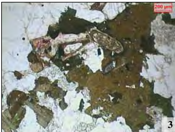
Fotomicrografia 3 - Agregado de biotita associada com allanita metamicta e fluorita intersticial (porção central inferior). Canto esquerdo biotita alterada para clorita com faixas marrom e verde. Nicóis //.
