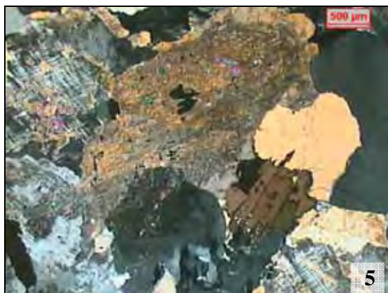
Fotomicrografia 5 - Plagioclásio com intensa substituição para mica branca no núcleo. A presença da biotita intensifica a alteração para mica branca nos cristais no seu entorno. Nicóis cruzados.
