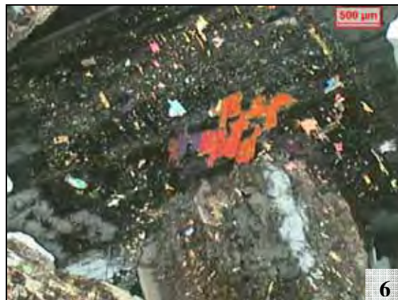
Fotomicrografia 5 - Plagioclásio zonado com borda albitica, e com núcleo contendo lamelas de mica branca, argilominerais e óxidos de ferro como produtos de alteração no núcleo. Nicóis cruzados.
