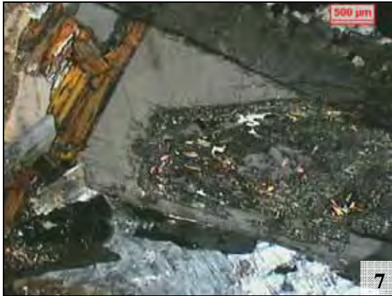
Fotomicrografia 7 - Plagioclásio zonado com borda albítica e núcleo mais cálcico e fortemente saussuritizado. Parte esquerda superior cristal de biotita parcialmente alterado. Nicóis cruzados.
