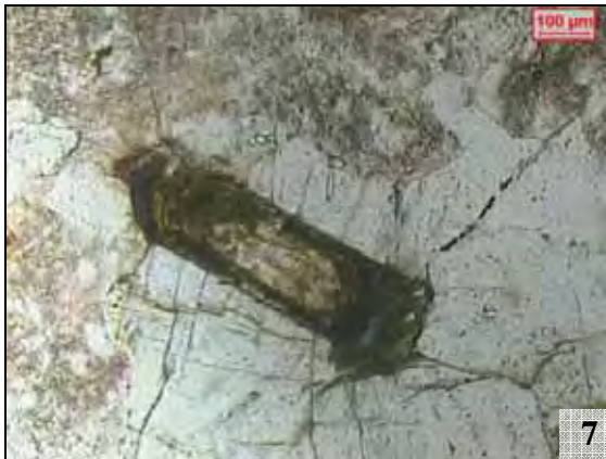
Fotomicrografia 7 - Cristal de allanita euédrica metamictizada, circundada por apatita microfissurada com planos dispostos em direções perpendiculares e preenchidas por opacos disseminados e óxidos de ferro. Porção superior e esquerda da seção com cristais de plagioclásio argilizados e com presença de óxidos/hidróxidos de ferro. Nicóis paralelos.
