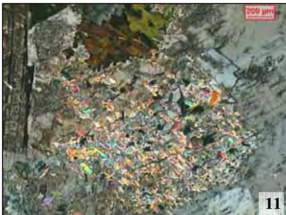
Fotomicrografia 11 - Detalhe da fotomicrografia (6), acima; notar a presença de argilominerais e de minerais opacos intercalados às lamelas de mica branca. Nicóis cruzados.
