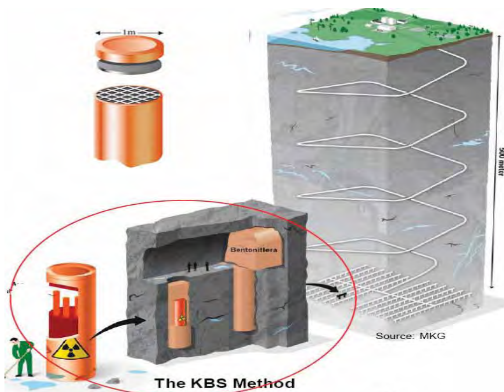
Figura 28. Dimensões das cápsulas comparadas com um ser humano e a instalação do repositório (MKG, 2010).
