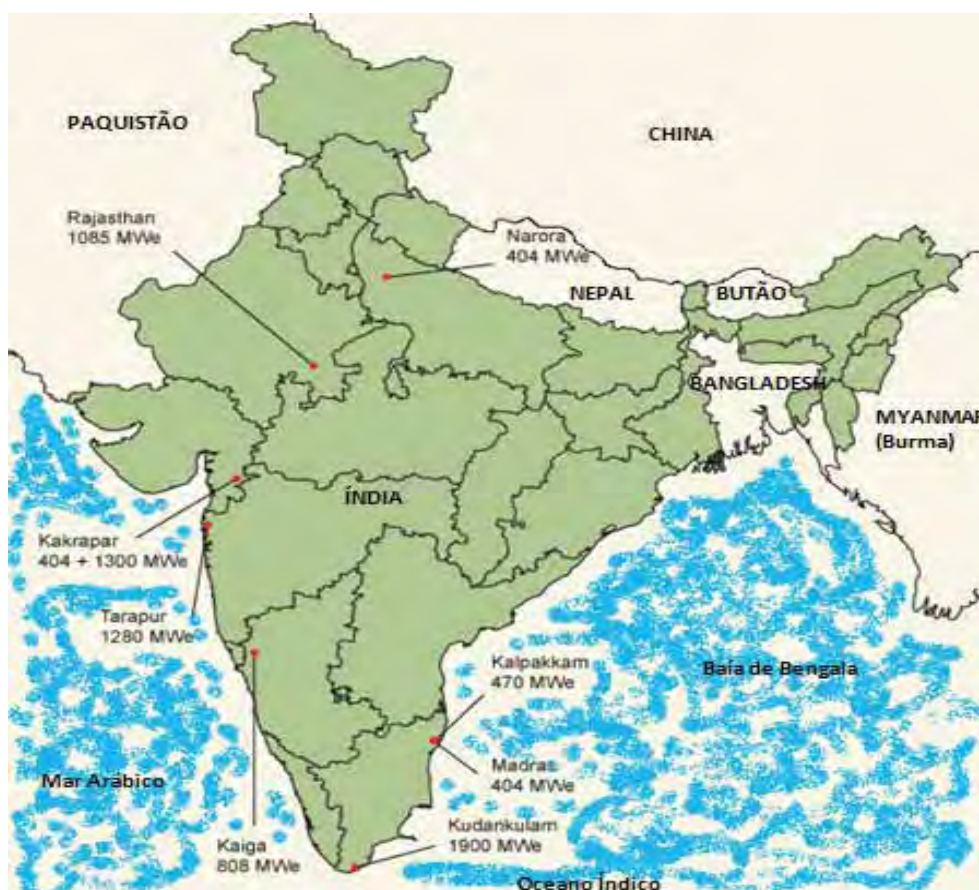
Figura 08. Mapa da Índia com os nomes de suas usinas nucleares e potência em megawatts de eletricidade (WNA, 2010h).
