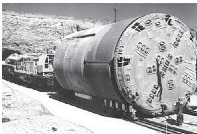
Figura 18. Foto da Tuneladora 16 utilizada para a escavação da montanha Yucca (THELIVINGMOON, 2001).
