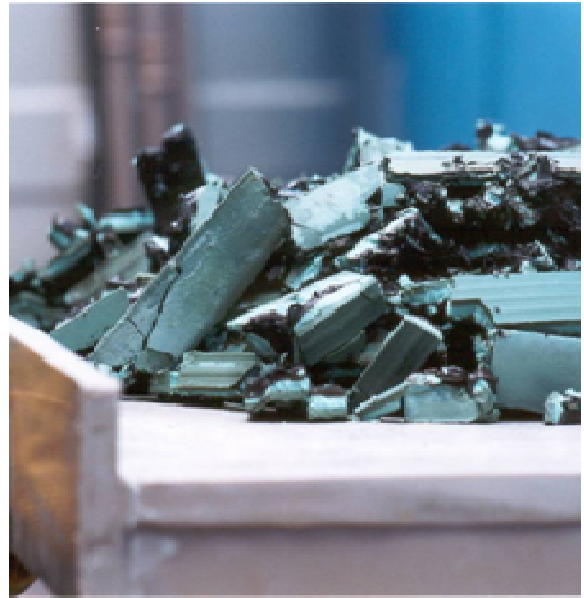
Figura 4.2. Resíduo galvânico “in natura” Z&Z Folheados.
