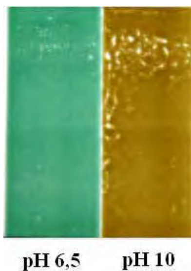
Figura 5.16. Hidróxidos separados por faixas de pH.
