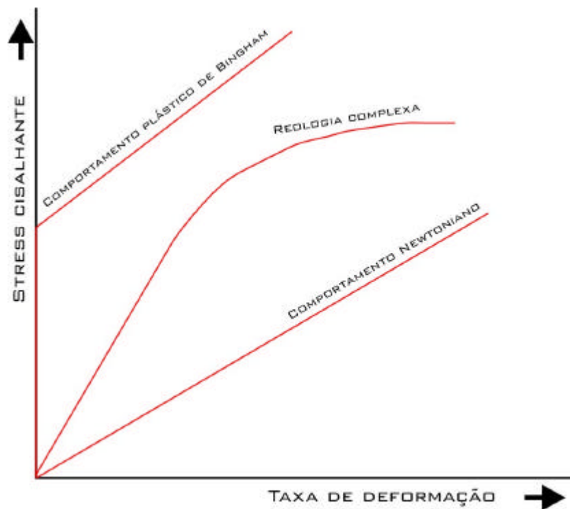
Figura 2.3 – Stress cisalhante versus taxa de deformação para reologias teóricas e ideais (Molyneux 1997).
