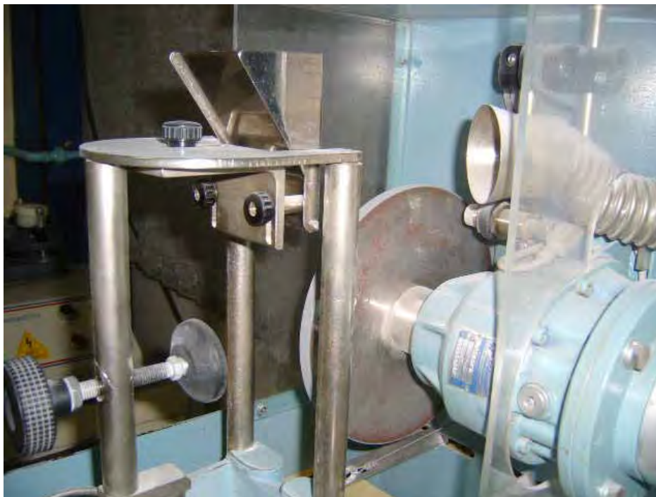
Figura 8.3. Equipamento utilizado para ensaio de Abrasão Profunda (CCB Centro Cerâmico do Brasil. Santa Gertrudes-SP).
