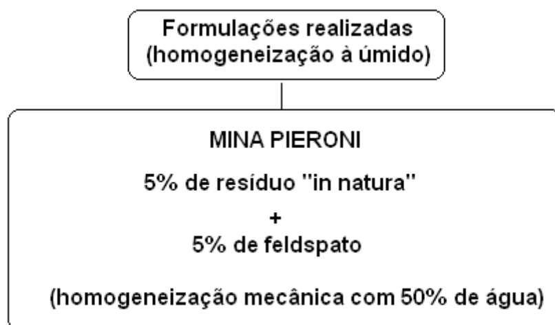
Figura 4.12. Fluxograma de preparação dos corpos prova, com homogeneização à úmido.
