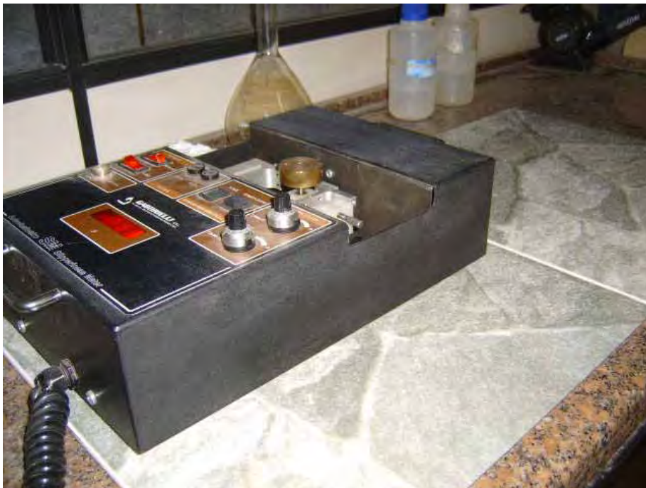
Figura 8.4. Equipamento Tortus utilizado para ensaio de Coeficiente de Atrito (CCB Centro Cerâmico do Brasil. Santa Gertrudes-SP).
