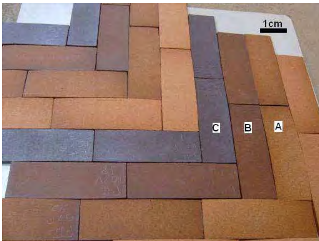
Figura 5.15. Corpos de prova 7X14cm queimados na Cerâmica Batistella, com (A)0%, (B) 5% e (C)10% dos resíduos das empresas Z&Z Folheados e Galvânica AZ e as argilas Pieroni roxa e Pieroni clara.
