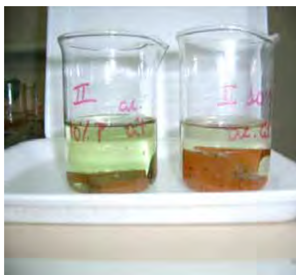
Figura 5.19. Amostra Pieroni clara com 10% de resíduo em ácido clorídrico (18%).
