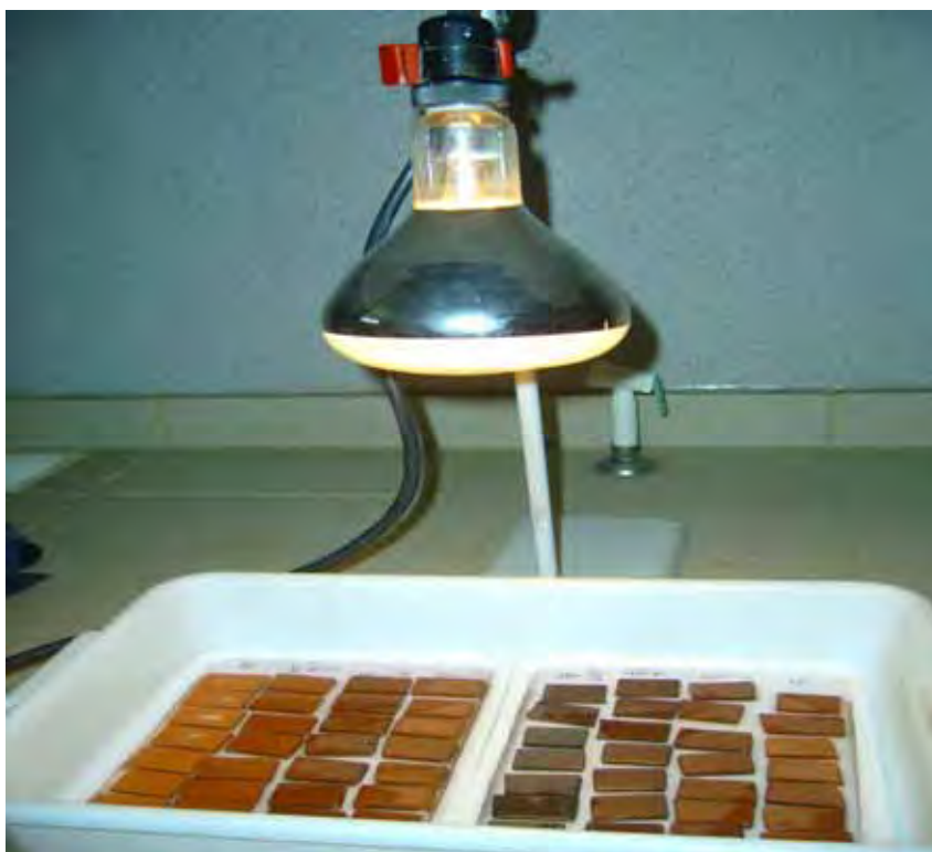
Figura 8.5. Ensaio de eflorescência.
