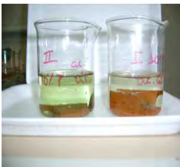
Figura 5.18. Amostra Pieroni clara com 10% de resíduo em ácido cítrico (100g/L).
