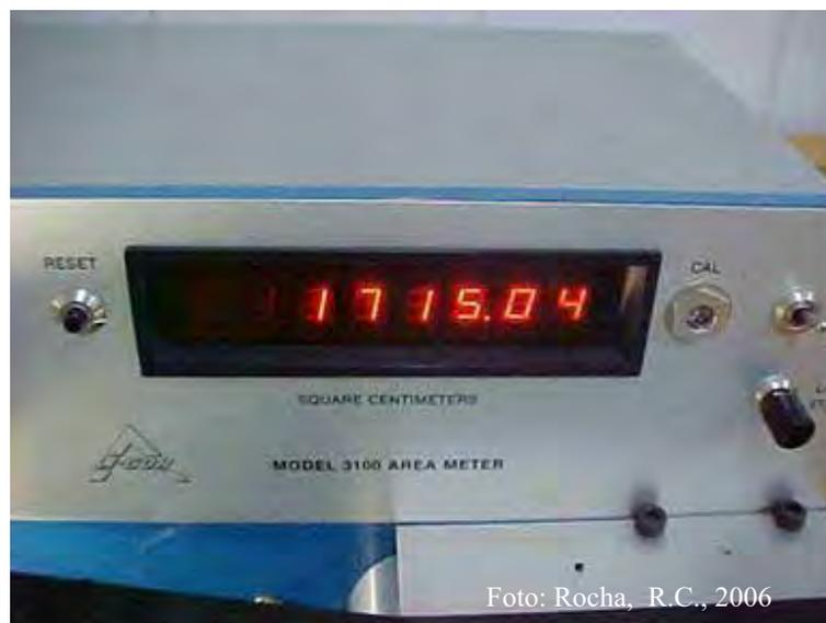
Figura10 – Medidor de área foliar, LI-COR MODEL LI-3100.
