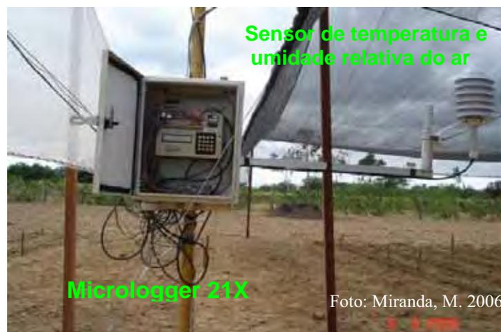
Figura 7 - Sistema automático de coleta de dados e sensor de temperatura e umidade relativa do ar.
