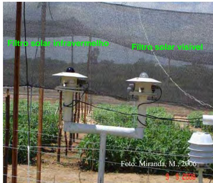
Figura 6 - Piranômetros espectrais Eppley
