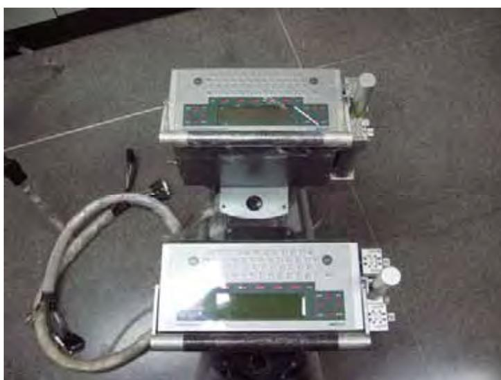
Figura 9 – Medidor das trocas gasosas IRGA, 6400 LI-COR.
