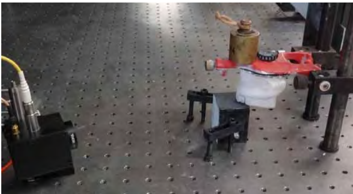
Figura 19 - Aplicação do carregamento no ensaio de interferometria holográfica.
