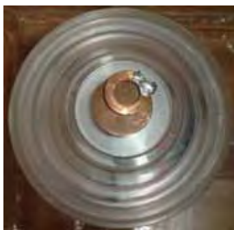
Figura 3.10 – Coletores de cobre no compartimento de acrílico da nova câmara piroelétrica.
