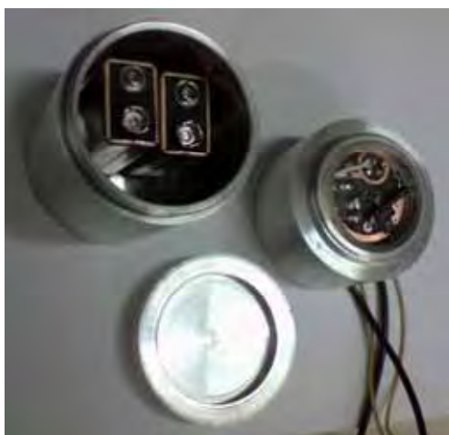
Figura 3.8 – Gabinete metálico da câmara piroelétrica.
