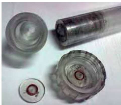
Figura 3.9 – Duto de acrílico preenchido com alloy e compartimento de acrílico desenvolvido para alojar os sensores piroelétricos.
