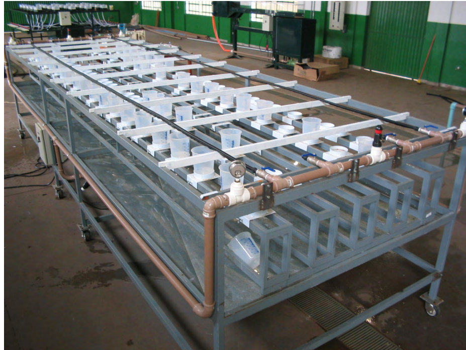
Figura 5. Vista geral da bancada de ensaios de emissores para gotejamento.
