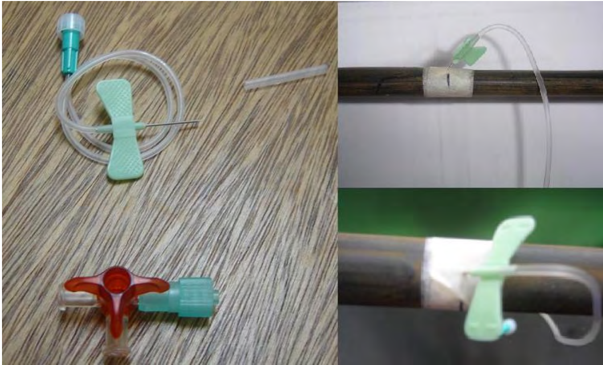
Figura 11: Detalhe da agulha e da torneira de três vias e conexão da agulha com mangueira gotejadora.
