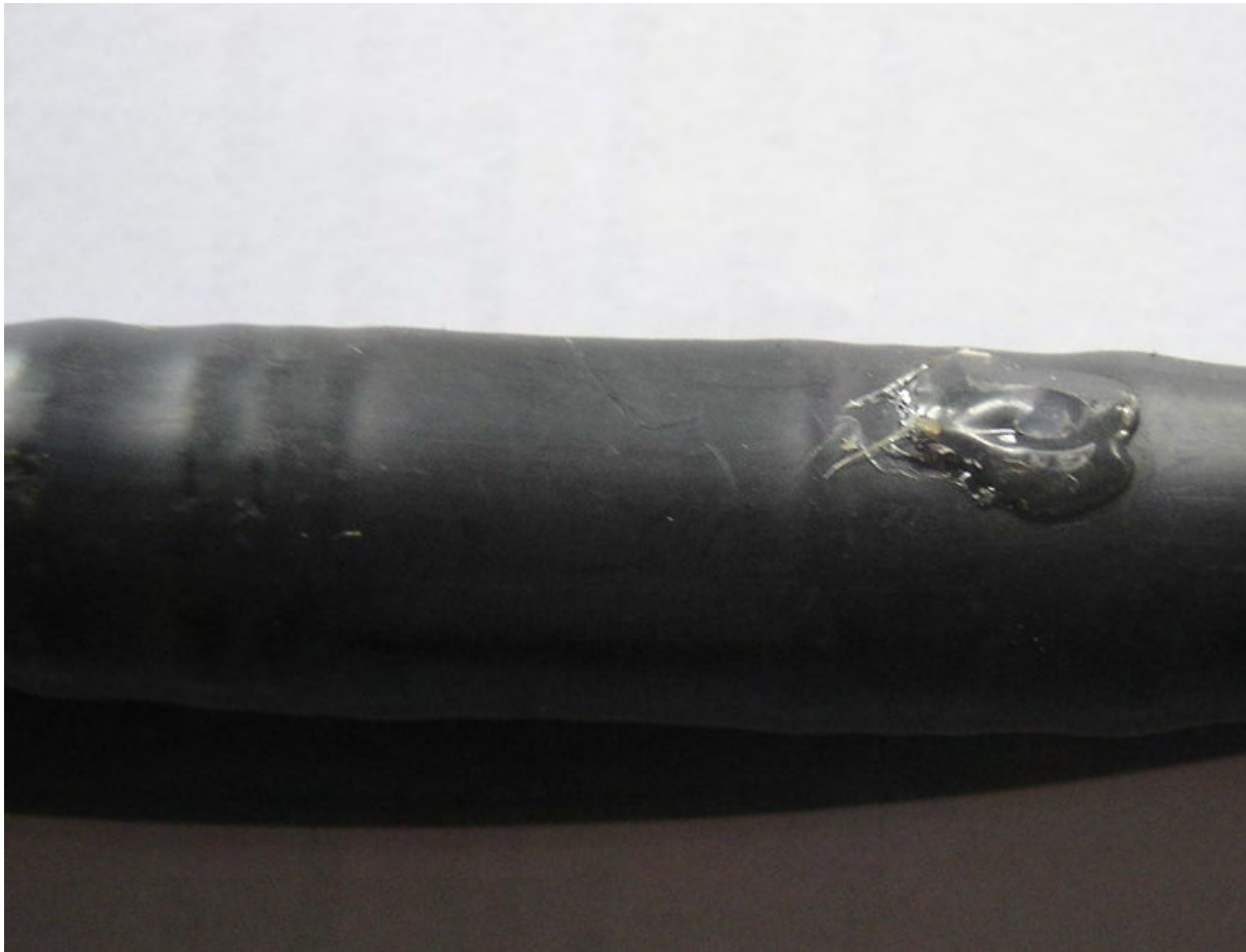
Figura 13: Detalhe do gotejador fechado com cola de silicone.
