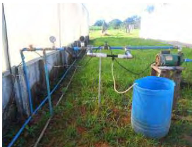
FIGURA 6. Sistema de bombeamento e injetor de fertilizante tipo Venturi.
