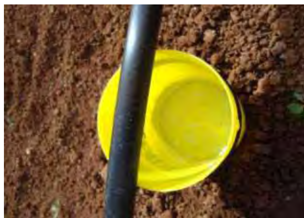
FIGURA 8. Coletor utilizado na determinação da uniformidade de distribuição de água.
