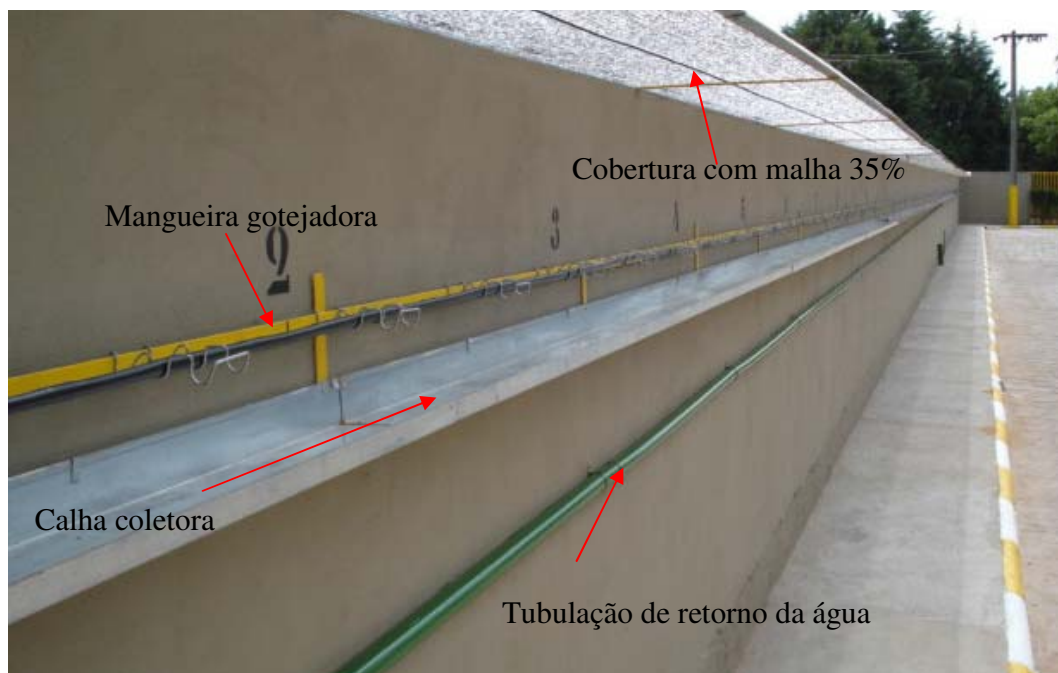
Figura 12. Vista da plataforma suspensa para ensaios das mangueiras gotejadoras.
