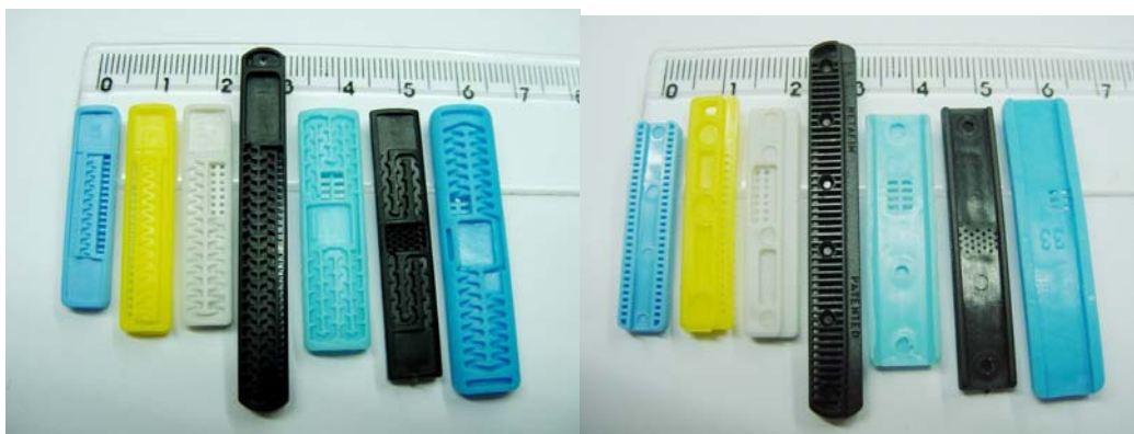
Figura 7. Gotejadores planos, vista da face superior com os labirintos e vista inferior com os pré-filtros. Escala em mm.
