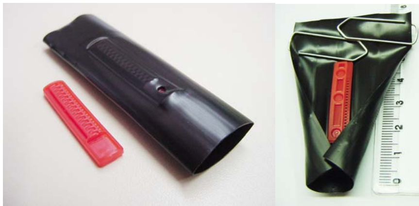
Figura 6. Gotejador com face labirinto para cima, MGC com gotejador soldado e furo para saída de água e mangueira com corte transversal mostrando o gotejador soldado.
