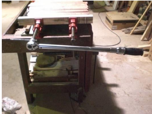
Figura 3.17 – Amostras sendo prensadas com aplicação de torque de 16 N·m.
