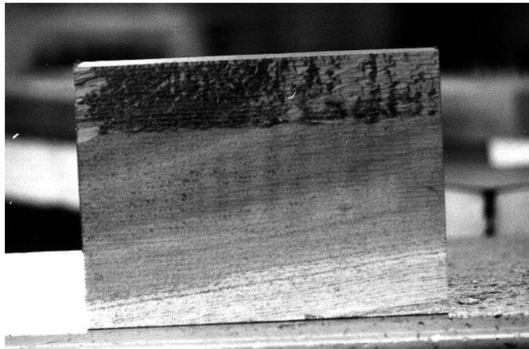
Figura 2.8 - Acabamento superficial na formação do cavaco Tipo I e II, direção discordante (superior) e concordante (inferior) das fibras, respectivamente. Madeira: Cedro, U_{BU} = 12\% , \gamma_f = 25^\circ e h = 1,5 mm mm (GONÇALVES, 2000).
