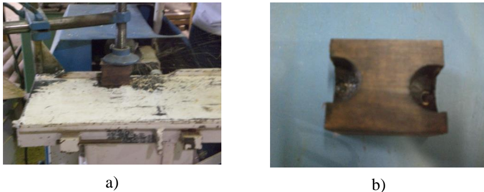
Figura 3.22 - a) 1ª etapa para gerar o semicírculo nos CPs, b) Detalhe: Geração dos semicírculos.
