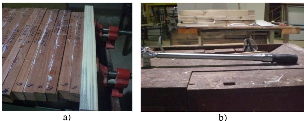
Figura 3.16 – a) Amostras sendo preparadas para a prensagem, b) Detalhe: Torquímetro utilizado.
