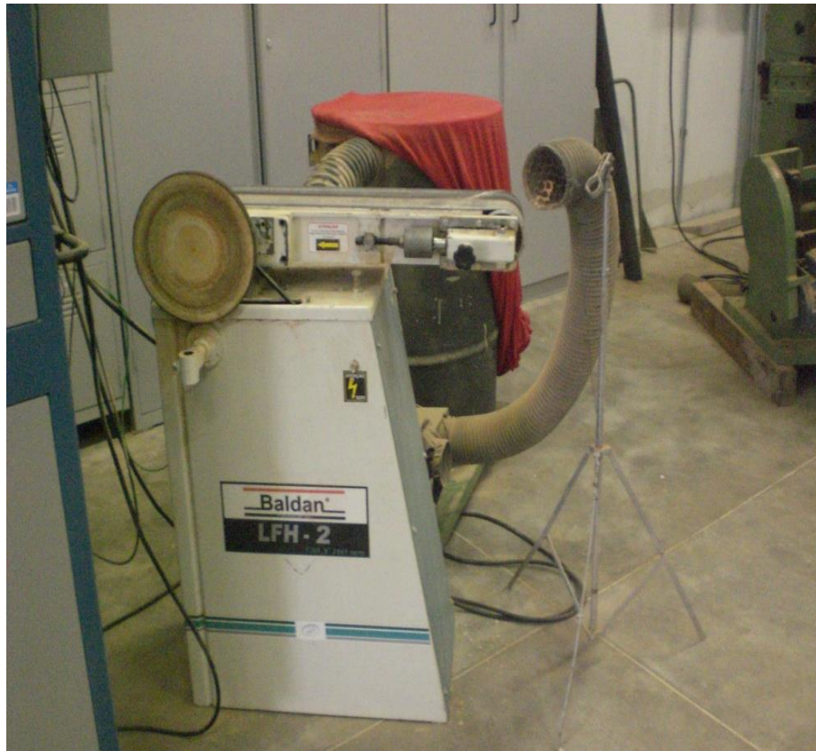
Figura 3.8 – Lixadeira de cinta de mesa horizontal empregada no lixamento das superfícies.
