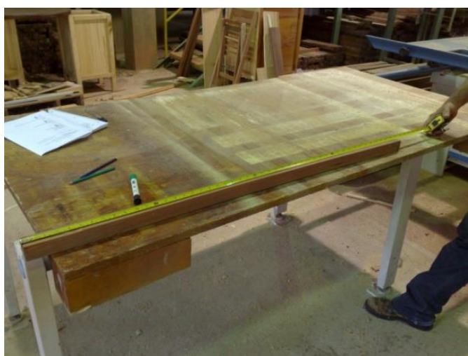
Figura 3.4 – Ilustração do início de marcação das peças para confecção das amostras.
