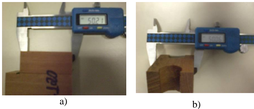
Figura 3.24 – Detalhes das medições realizadas nos CPs para submissão aos ensaios mecânicos.
