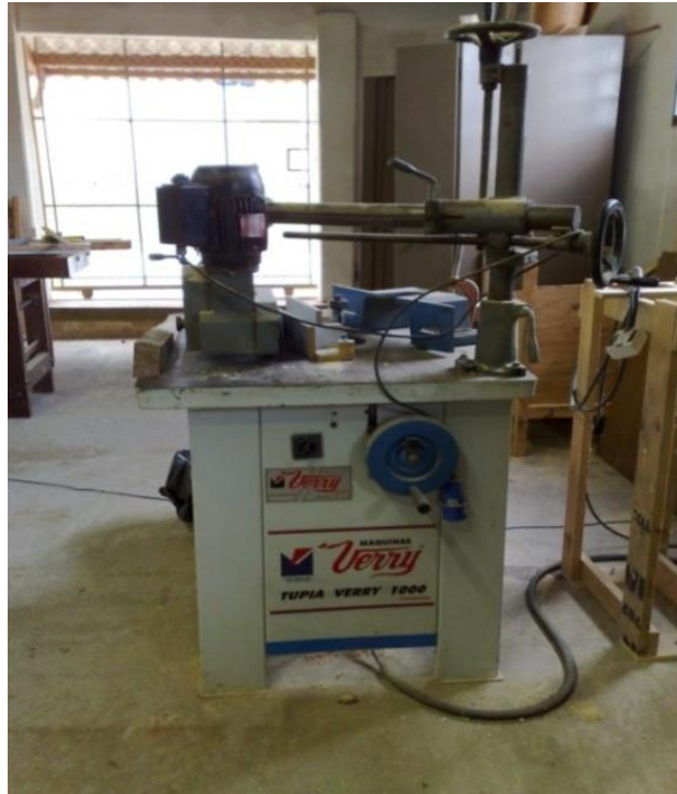
Figura 3.6 – Fresadora (denominada por “Tupia Moldureira”) equipada com alimentador de avanço, utilizada na geração das superfícies de colagem das peças, para posterior lixamento e produção dos CPs.
