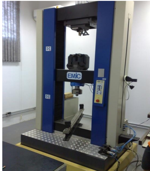
Figura 3.27 – Vista geral da máquina de ensaios universal de caracterização mecânica de materiais.
