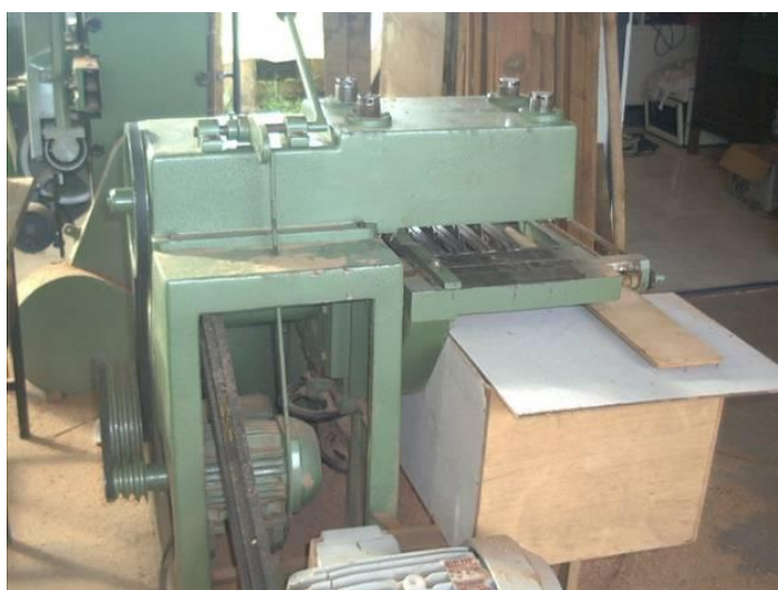
Figura 3.2 - Serra circular multilâminas, empregada para geração de peças na forma de sarrafos.
