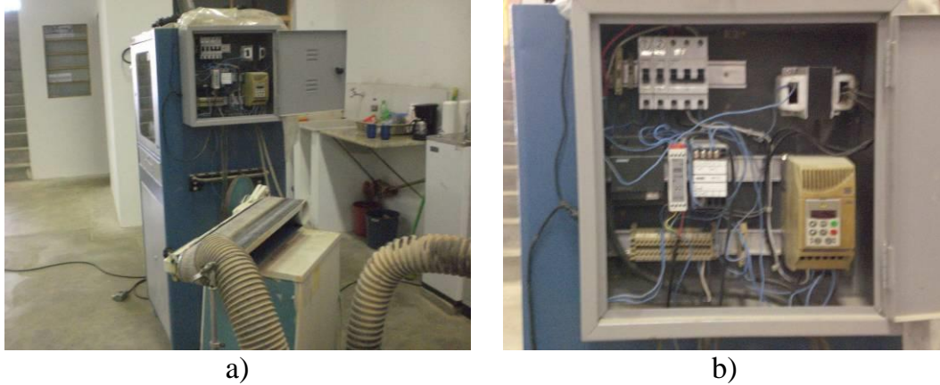
Figura 3.9 – Lixadeira utilizada: a) Conjunto lixadeira e Painel de controle, b) Detalhe: Painel de controle.
