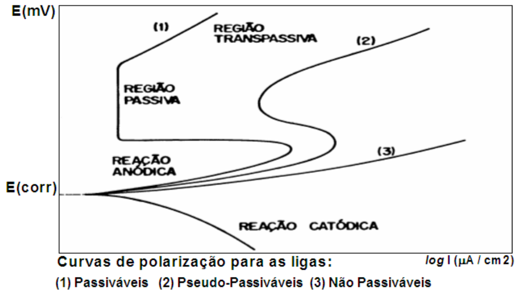
Figura 3.14 – Curvas esquemáticas de polarização potenciodinâmica [BABOIAN, R., 1976]
