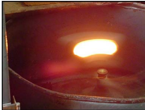
Figura 3.3 – Preenchimento do molde com a liga refundida
