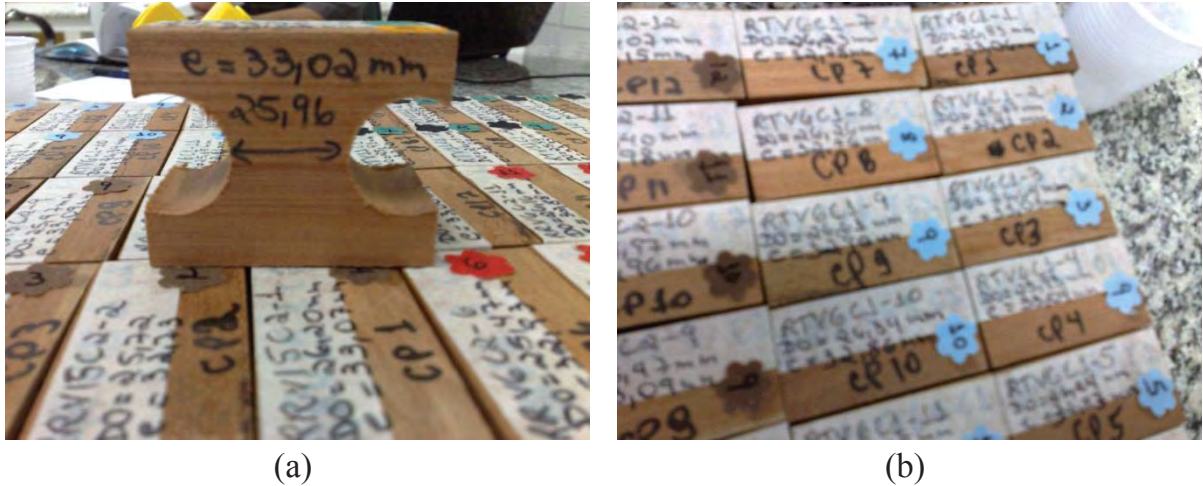
Figura 3.19 – Corpos de prova preparados para o ensaio de tração normal. (a) detalhe da dimensão de largura e , (b) identificação dos corpos de prova.
