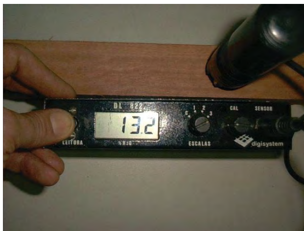
Figura 3.5 - Detalhe de medição de umidade em peça de madeira após secagem por ventilação forçada.
