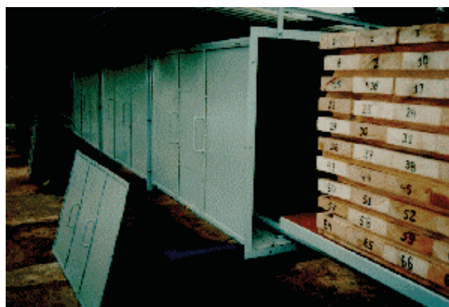
Figura 3.3- Detalhe das pilhas de madeira serrada sendo introduzidas no secador.
