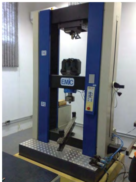
Figura 3.14 – Vista geral da máquina de ensaios universal de caracterização mecânica de materiais.
