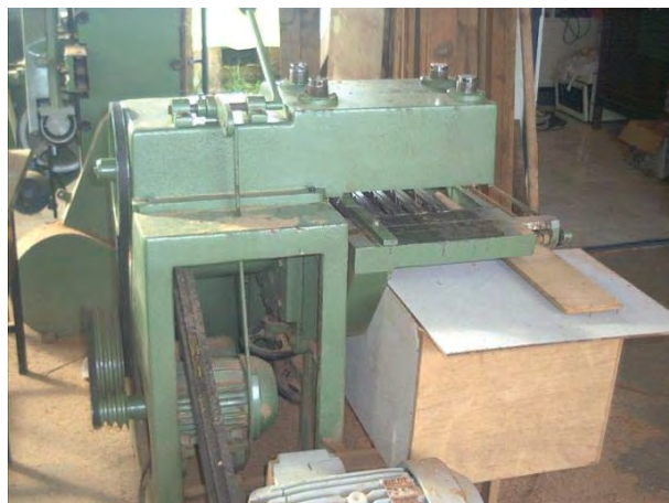
Figura 3.4 - Serra circular multilâminas, empregada para geração de peças na forma de sarrafos.
