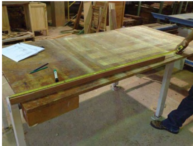
Figura 3.6 – Ilustração do início de marcação das peças para confecção de amostras coladas.
