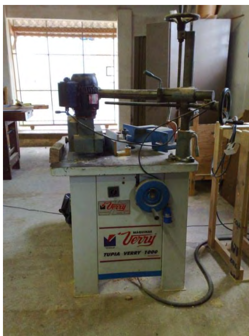
Figura 3.9 - Ilustração da “Tupia Moldureira” equipada com alimentador de avanço, utilizada na geração das superfícies de colagem das peças, para posterior produção dos corpos de prova.
