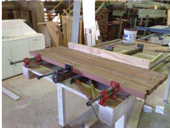
Figura 3.11 – Ilustração da prensagem dos pares de peças por grampos de rosca.
